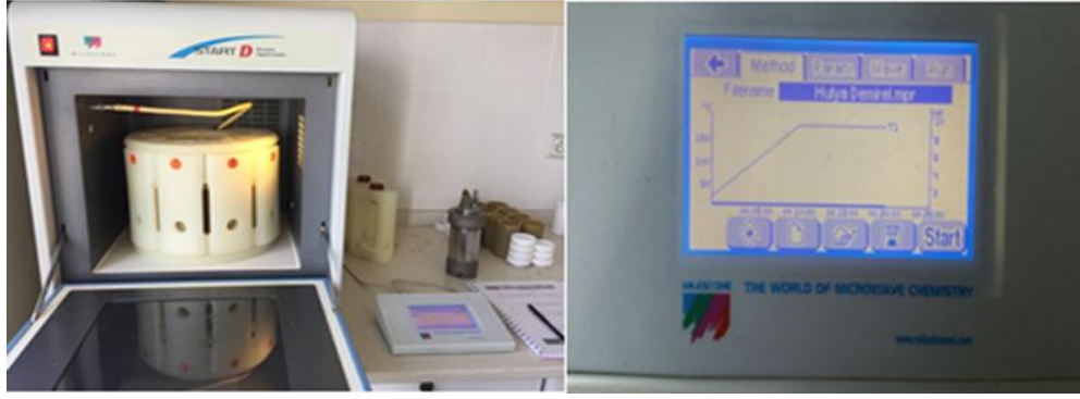
Şekil 3.14. Numunelerin mikrodalga cihazında çözünürleştirilmesi
