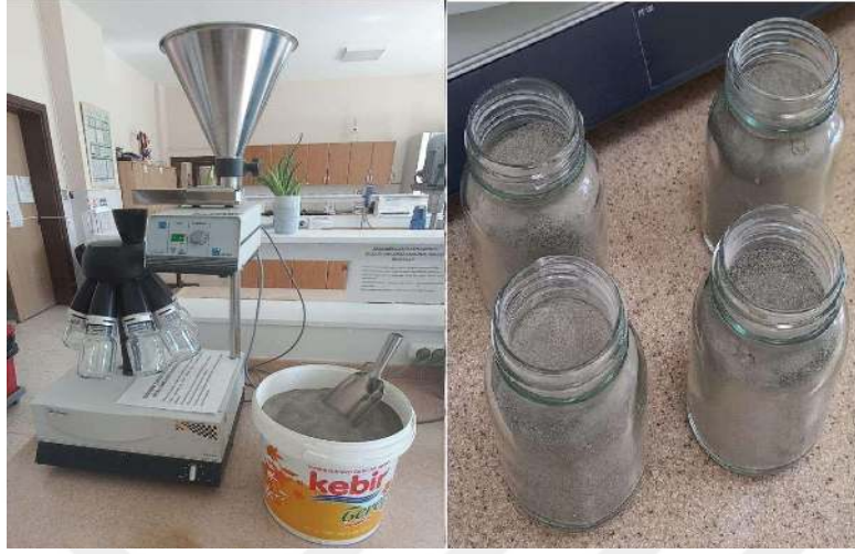
Resim 3.1 Numune hazırlama çalışmalarında kullanılan kavanozlu numune bölücü.
