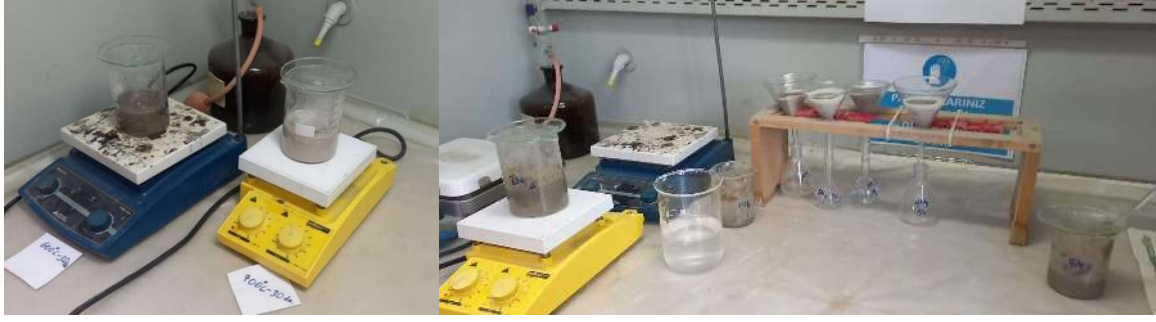
Resim 3.4 Deneylerin gerçekleştirildiği manyetik karıştırıcılar ve süzme düzeneği.
