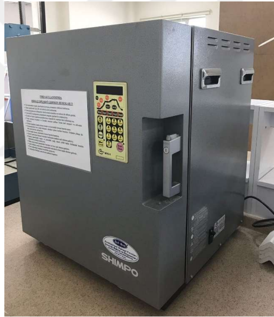
Resim 3.2 Termal aktivasyon işlemlerinde kullanılan kül fırını.
