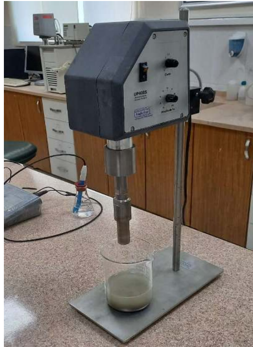
Resim 3.3 Mekanik aktivasyonda kullanılan Hielscher UP400S ultrasonik homojenizatör.
