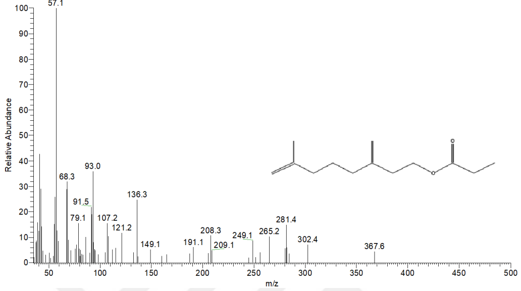
Şekil 4.240: 4 No.lu (P9) Sarıçam yaprağı ekstraktına ait 7-Metil-3-metilen-7-okten-1-ol,propanoat (ester) GC-MS kromatogramı.
