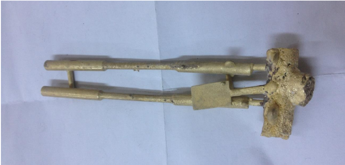
Şekil 7.5 Dökümün ardından hava ve su ile soğutulan derece
