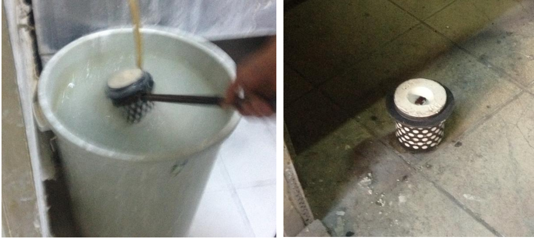
Şekil 7.5 Dökümün ardından hava ve su ile soğutulan derece
