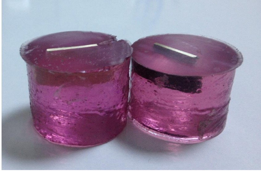
Şekil 7.9 Monteye alınmış numuneler
