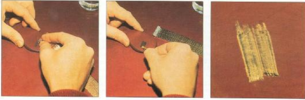
Şekil 4.1 Mihenk taşı ile ayar tespiti [21]
