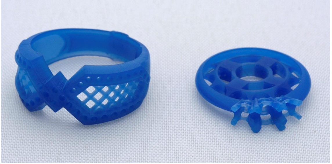
Şekil 6.5 Kuyumculukta kullanılan yüzüklere ait mum model örnekleri [38]
