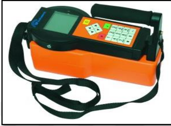
Şekil 3.3. Gama-ışını spektrometresi (Kontrol ünitesi ve el probu)
