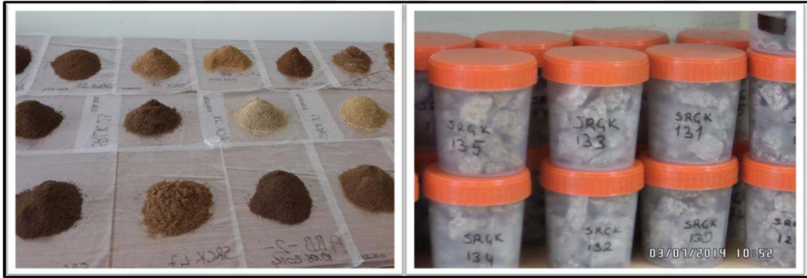
Şekil 3.6. Araziden toplanıp kurumaya bırakılan toprak örnekleri ve çeneli kırıcı yardımıyla boyutları küçültülen kayaç örnekleri
