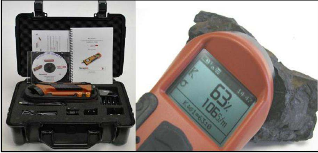
Şekil 3.4. KT-10 Plus S/C Suseptibilite ölçer ve ekipmanları
