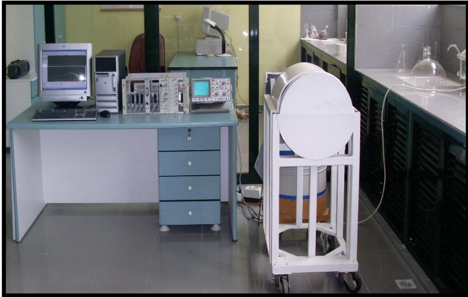
Şekil 3.7. HPGe dedektörlü Gama spektrometre sisteminin genel görünüşü
