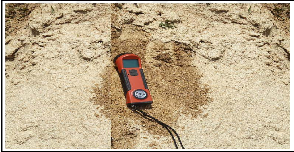
Şekil 4.8. Sarıçiçek granodiyoritinde (Gümüşhane) ayrılmış kayaktan oluşan toprak üzerinde manyetik suseptibilite ölçümü
