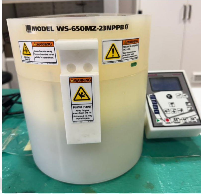
Şekil 3. LTO elektrotlarının üretiminde kullanılan spin-coating sistemine ait bir görsel.
