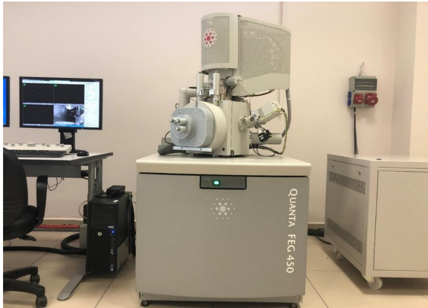
Şekil 13. Numunelerin yüzey morfolojisinin incelenmesi için kullanılmış olan taramalı elektron mikroskobuna ait bir görsel.
