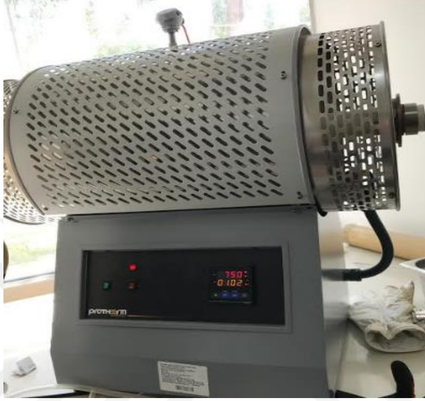
Şekil 2.2. Peletlerin 750 0 C sıcaklıkta 24 saatlik ısıtılma tabi tutulduğu yüksek sıcaklık fırını
