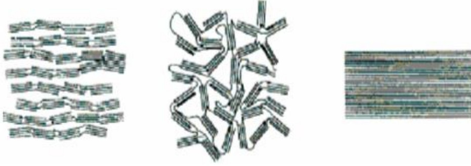
Şekil 1.19. Karbon yapıları. a)yumuşak karbon, b)sert karbon, c)grafit [25].
