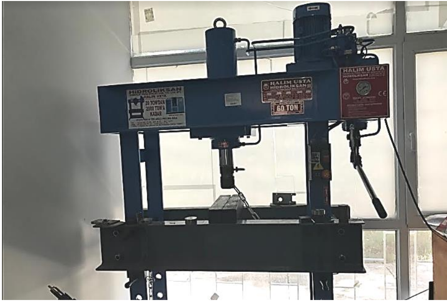
Şekil 2.1. 50-60 atm basınç altında pelet yapmak için sıkıştırılma işlemi yapılan düzeneği.
