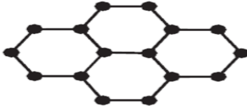
Şekil:1.18. Karbon tabakasının hekzagonal yapısı [19].
