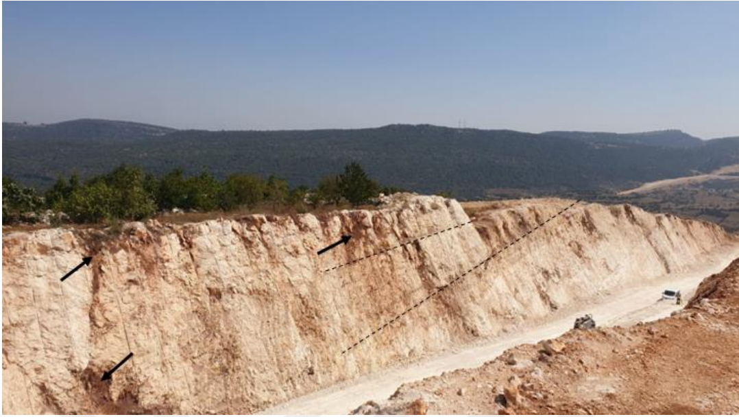
Şekil 4.3. Karaisalı formasyonuna ait kireçtaşlarının Tarsus-Çamlıyayla yol yarmasında yüzeyleyen bej renkli taze yüzeylerinde gözlenen GD'ya doğru eğimli kalın tabakalı (siyah kesikli çizgiler) ve karstik erime boşluklu (siyah renkli oklar) yapısından bir örnek
