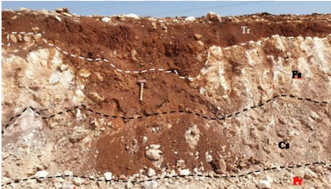
Şekil 4.17. Otokton-yarı allokton karstik bir ayrışma profilinde altta bulunan anakayaç (Pr) üzerine gelen kısmen ayrışmış kaba (Cs) ve daha iyi ayrışmış ince saprolitik (Fs) zonlar ile en üstte yer alan kırmızımsı kahve renkli Terra Rossa çökellerinin (Tr) tedrici geçişli sınır ilişkileri
