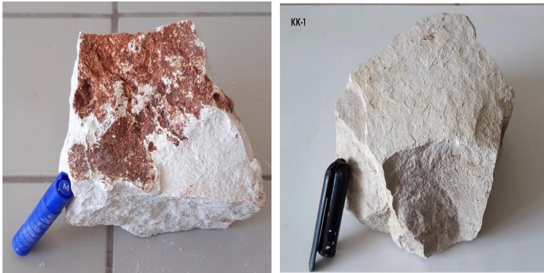
Şekil 5.1. Ana kayaçını temsil eden (KK-1) çok soluk turuncu (10YR 8/2), ince taneli ve masif dokuya sahip, krem renkli (Numarasız) el numuneleri
