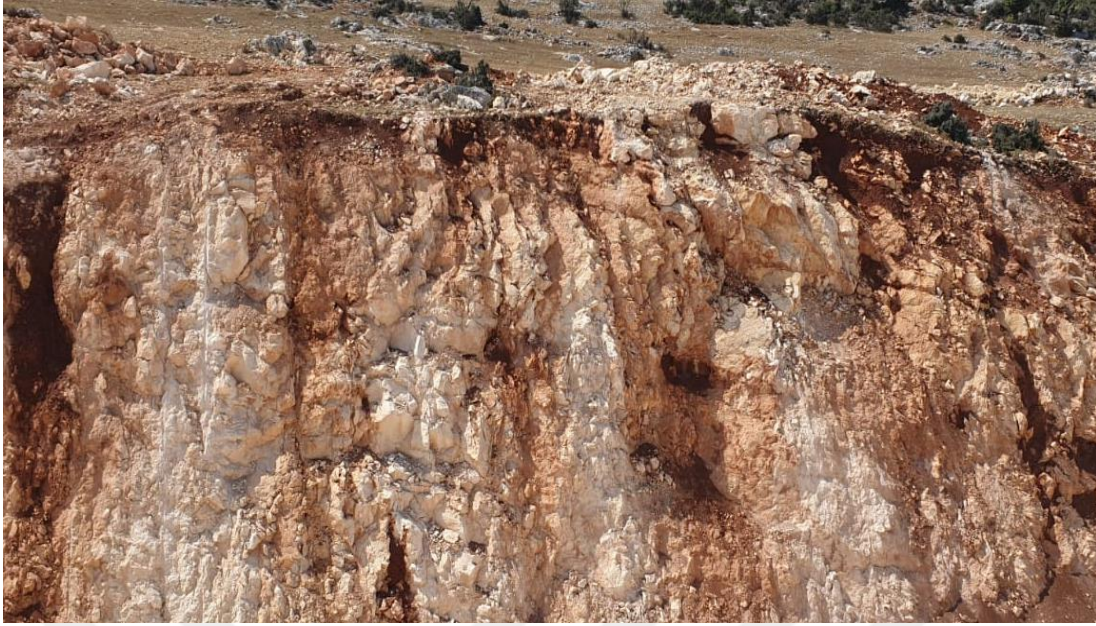
Şekil 4.7. Beyazımsı krem renkli killi kireçtaşlarından oluşan Karaisalı formasyonuna ait birimlerin yüzeysel ortam şartlarında ayrışma ve kartlaşması süreçlerinin birlikte etkimesi sonucunda ortaya çıkan kimyasal kalıntı tipi kırmızımsı kahve renkli Terra Rossa çökellerinin hem güncel doğal mostra görünümleri (morfolojideki görünüm) hem de yol yarmasında kazılmış taze görünümü. Anakayaç ile Terra Rossalar arasında otokton lateritik oluşuma işaret eden tedrici geçişli sınır ilişkisi gözlenmektedir
