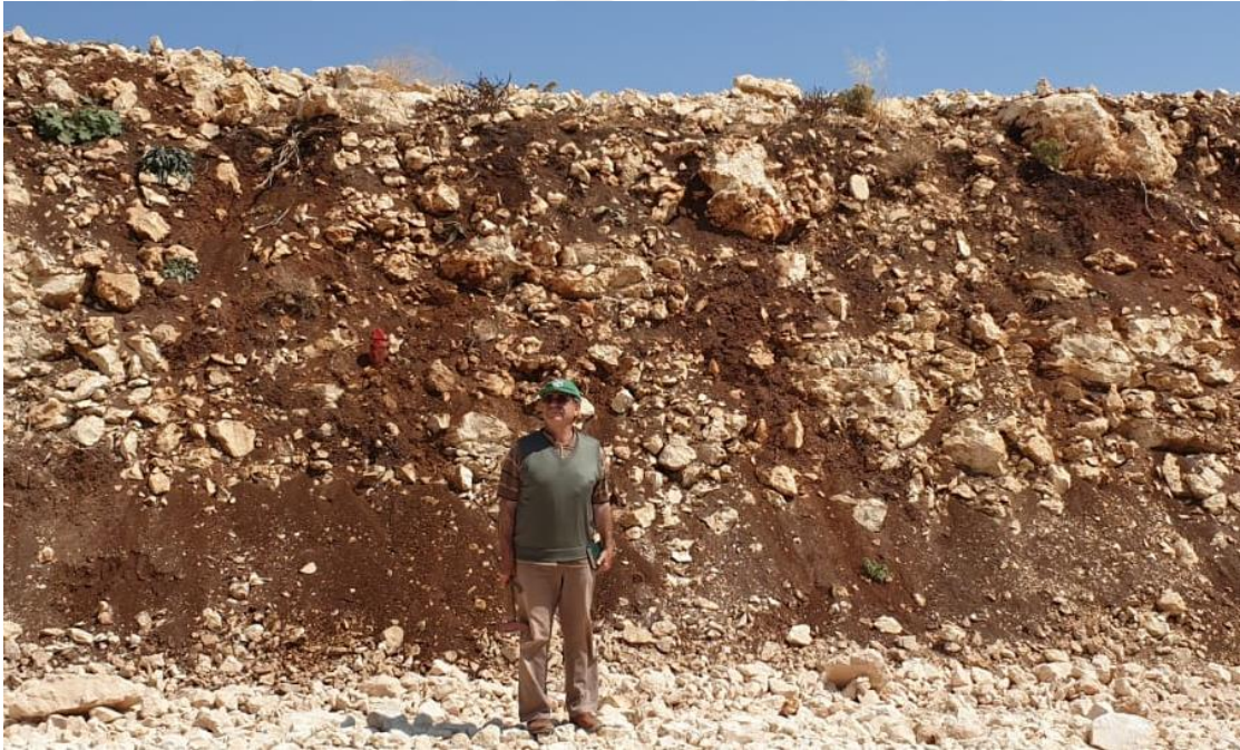
Şekil 4.19. İçerisinde Karaisalı formasyonuna ait bej renkli yerli kireçtaşı bloklarının da görüldüğü ancak daha çok kısa mesafeli taşınma gösteren kireçtaşı blok ve çakıl boyutlu köşeli parçalar içeren otokton-yarı allokton kırmızımsı kahve renkli Terra Rossa çökellerinin yol yarmasındaki görünümü
