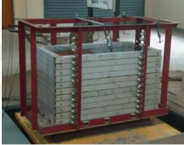
Şekil 2.9. Laminer zemin sarsma kutusu
