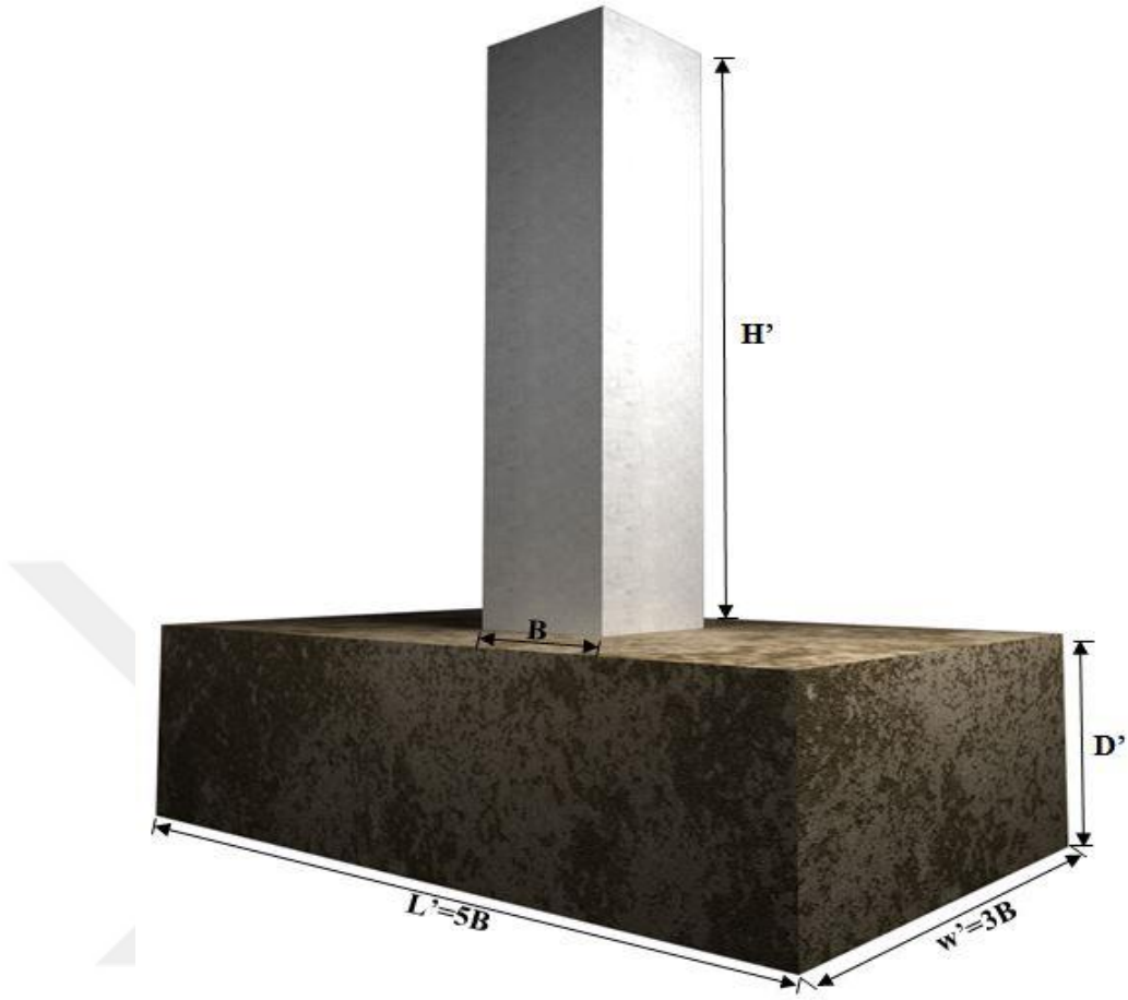
Şekil 3.2. Yapı-zemin etkileşim probleminin ölçekli modeli
