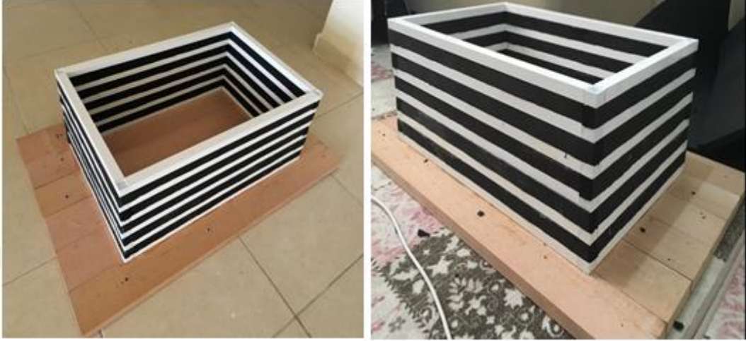
Şekil 4.10. Sarsma tablasına kullanacak zemin sarsma kutusunun genel görünümü
