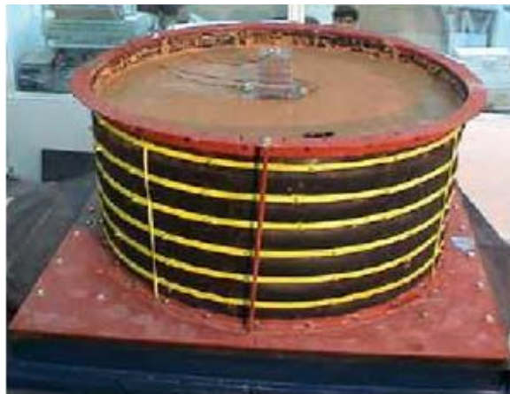
Şekil 2.8. Esnek silindir zemin sarsma kutusu [26]
