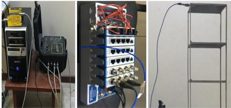
Şekil 4.14. İvme ölçerler ve veri toplama sistemleri
