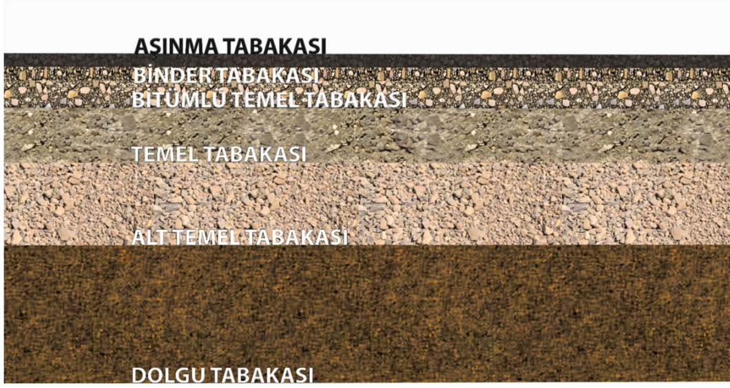
Şekil 5. Yüksek standartlı esnek üst yapı en kesiti
