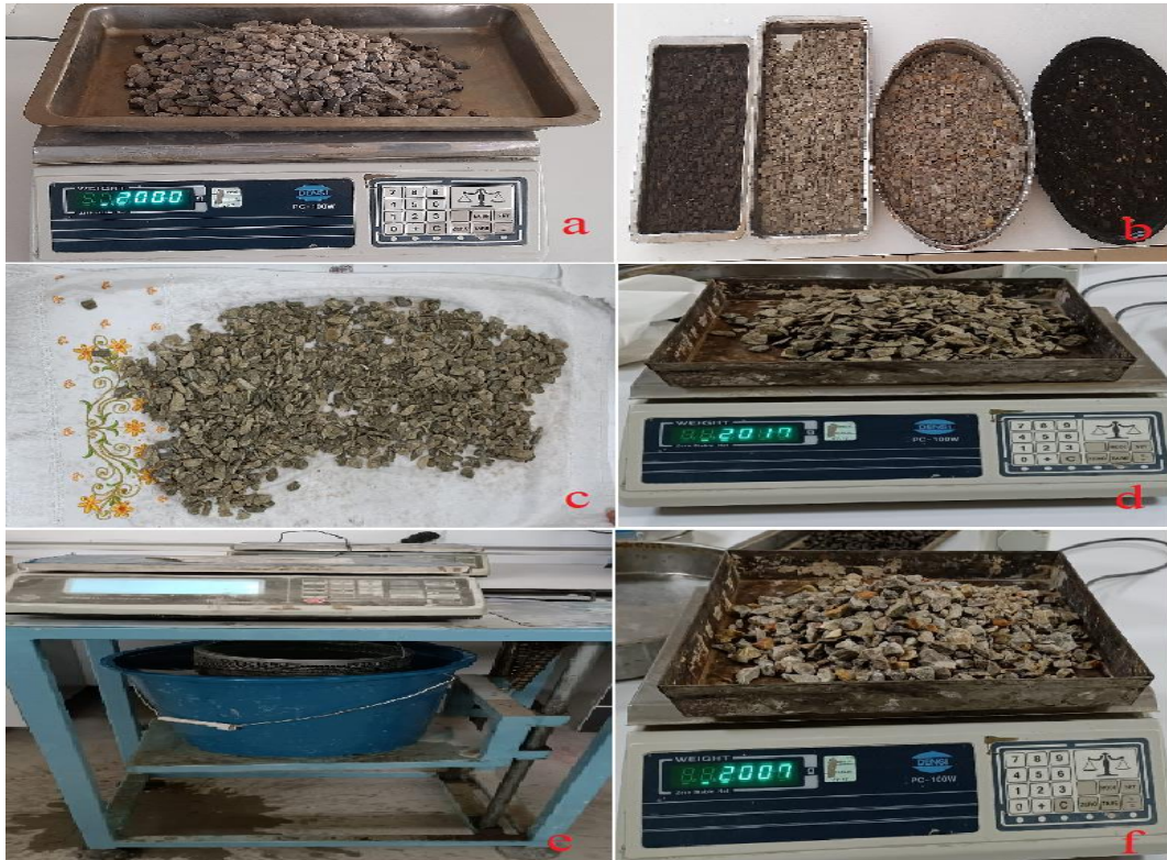
Şekil 4.3. İri Agrega Deney Aşamaları. a) Numunenin Hazırlanması, b) Numunelerin Suyu Koyulması, c) Numunelerin Peçete Yardımıyla Kurutulması, d) Numunelerin Tartılması, e) Agregaların Tel Sepetle Su Kovasına Konulması, f) Numunelerin Etüvde Kurutulduktan Sonraki Tartımı
