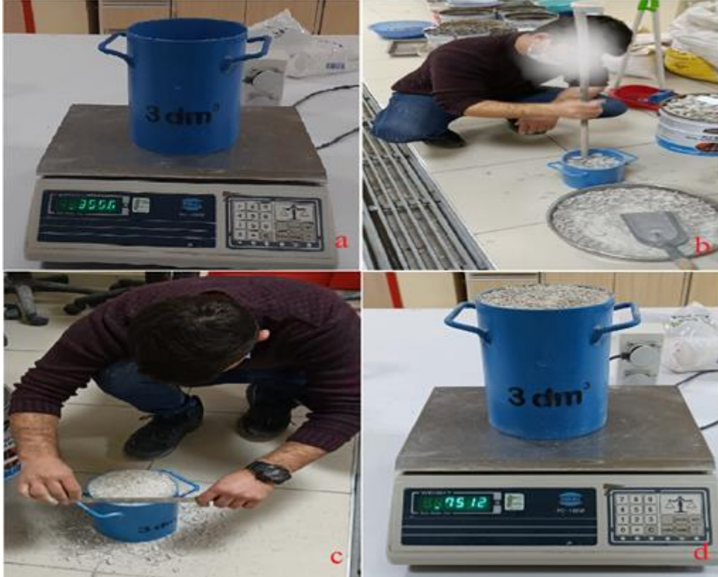
Şekil 4.4. Agreg Birim Hacim Ağırlık Deney Aşamaları. a) Hacim Kovasının Tartılması, b) Numunenin Şişlenmesi, c) Numunenin Tevsiyelenmesi, d) Numunenin Tartılması
