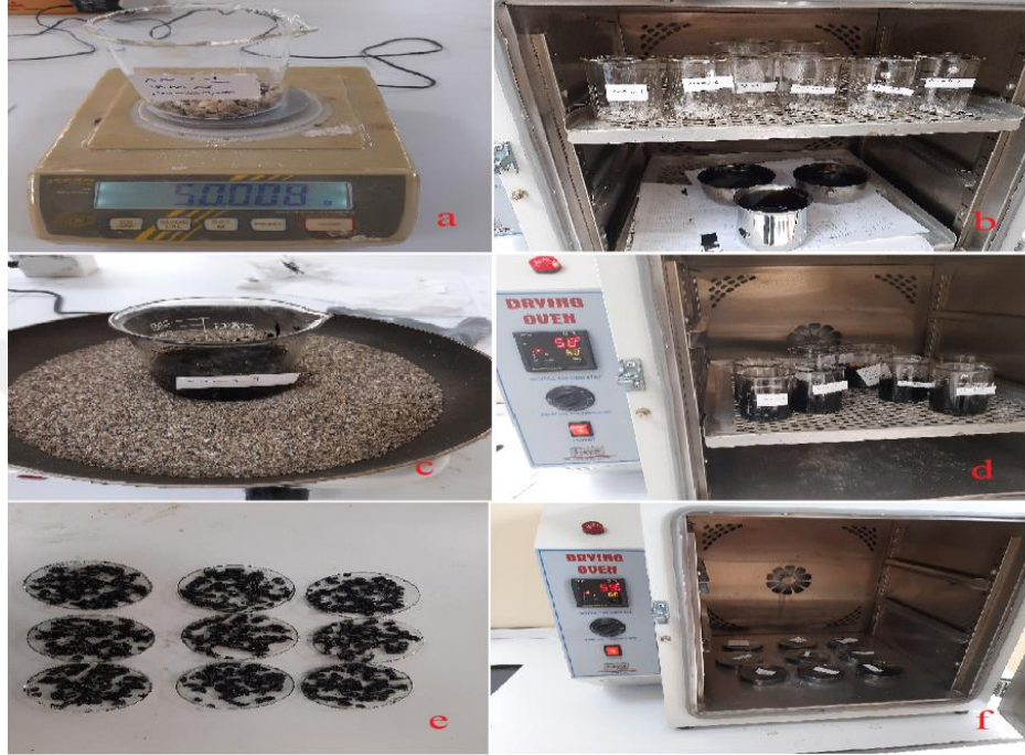
Şekil: 4.12. Nicholson Soyulma Deneyi Aşamaları. a) Agregaların Hazırlanması, b) Agreganın 1 saat Etüvde Bekletilmesi, c) Beherin Kum Banyosunda karıştırılması, d) Hazırlanan Numunelerin Etüvde Bekletilmesi, e) Beherdeki Numunelerin Petri Kabına Konulması, f) Su Dolu Petri Kaplarının Etüvde Bekletilmesi
