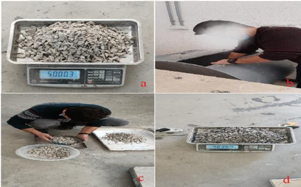
Şekil 4.1. Los Angeles Deney Aşamaları a) Numune Hazırlanması, b) Numunelerin Deney Aletine Yerleştirilmesi, c) Eleme İşlemi, d) Agregaların Eleme Sonucunda Tartılması
