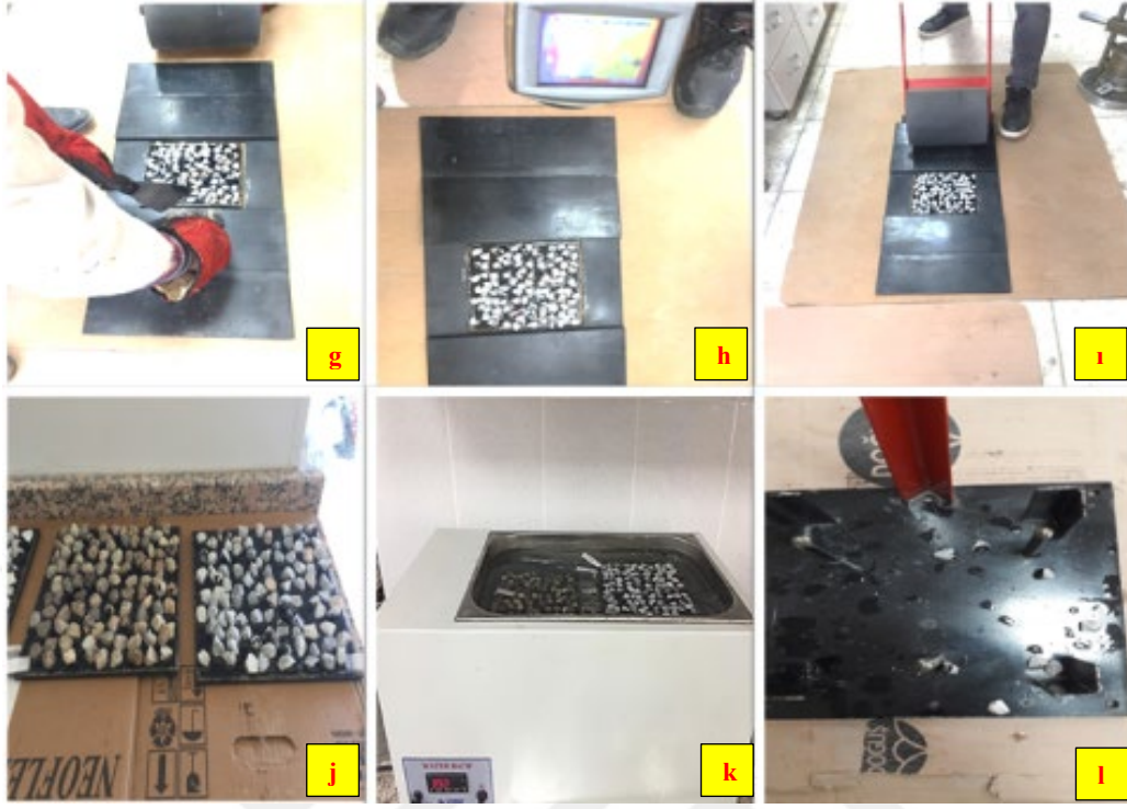
Şekil 3.3 Vialit deney aşamaları, g) Numunenin silindirlemeden önce klavuzlanması. h) Termometre ile sıcaklık kontrolü. ı) Silindirme. j) Numunelerin 35 °C sıcaklığına ulaşana kadar bekletilmesi. k) Su banyosuna numunelerin yerleştirilmesi. l) Bilya düşürme.
