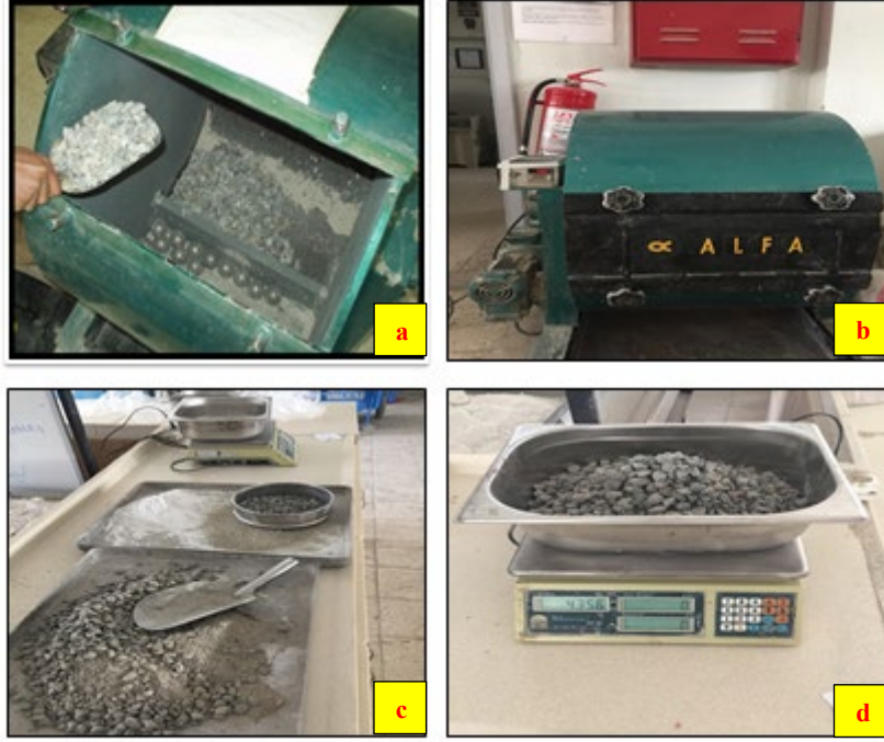
Resim 3.2 Los Angeles aşınma deneyi aşamaları, a) Agregaların ve Bilyaların Los Angeles Cihazına yerleştirilmesi. b) Cihaz kapağının kapatılması ve çalıştırılması. c) Cihazdaki agregaların eleme işlemi. d) Agregaların tartılması.
