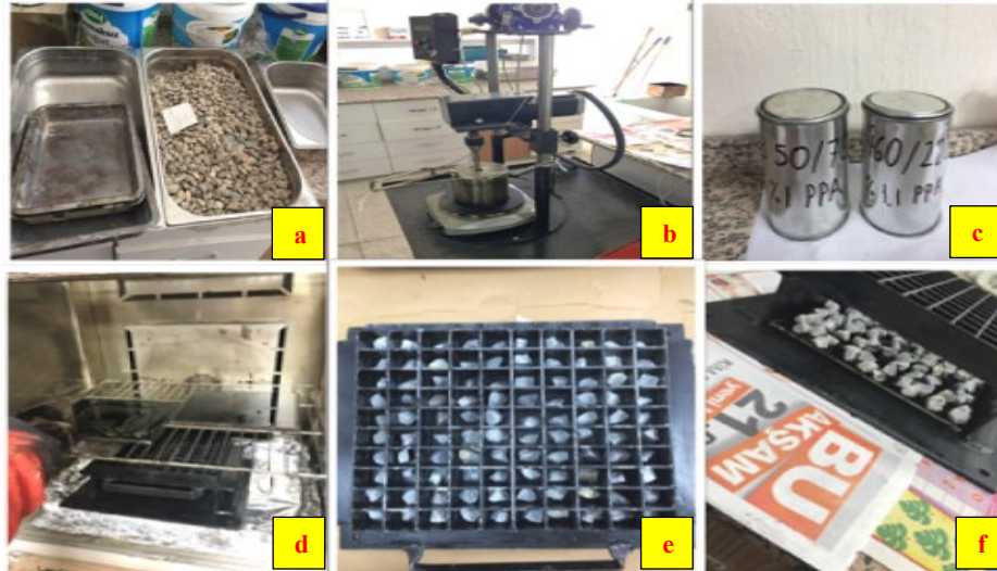
Şekil 3.2 Vialit deney aşamaları, a) Agregaların hazırlanması. b) Karışım işlemi. c) Hazırlanan modifiye bitüm numunesi. d) Etüvde plaka üzerindeki bitümün yayılması. e) Mekanik sericiye agregaların yerleştirilmesi. f) Sericiye plakanın yerleştirilmesi.
