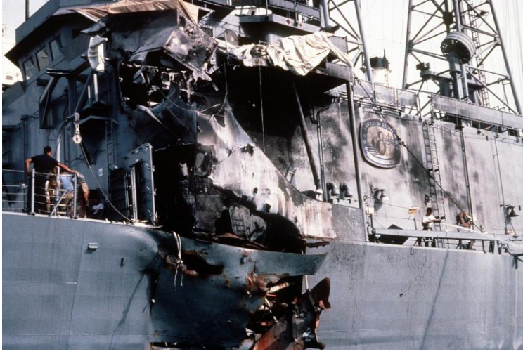
Şekil 2.11. USS STARK gemisinin köprü üstü hasarı [66]
