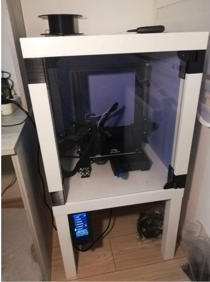
Şekil 4.1. Creality Ender 3 V2 için dış ortamdan ısı alışverişini kesici kasa yapımı
