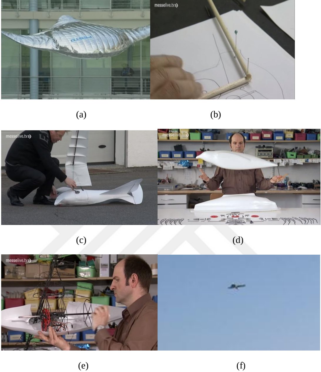
Şekil 2.27. SmartBird’ün başarı adımları (a) balonla deneme; (b) el çizimleri; (c) mekanizmanın ilk testi; (d) revize işlemleri; (e) revize sonrası montaj; (f) ilk uçuş anı
