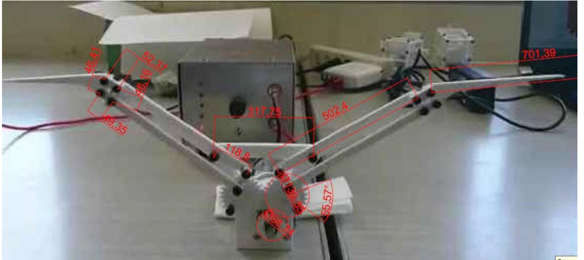
Şekil 3.10. Gerçek kanat ölçülerinin mesnetli kanat profiline sahip bir ornithopter mekanizmasına uyarlanması
