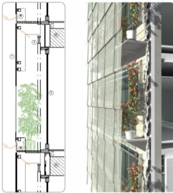
Şekil.2.24. Boşlukta bitki bulunan çift cidarlı cepheden dikey kesit [23]
