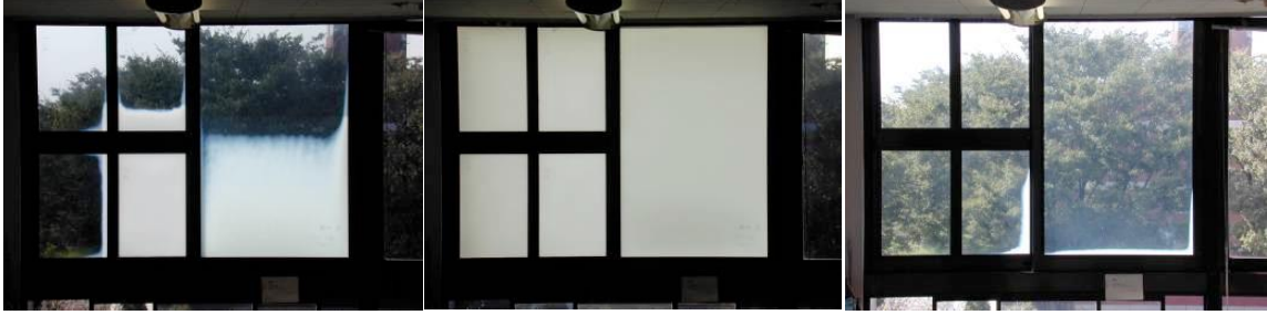
Resim 2.14. Termokromik camın değişik durumlarda görüntüleri [84].
