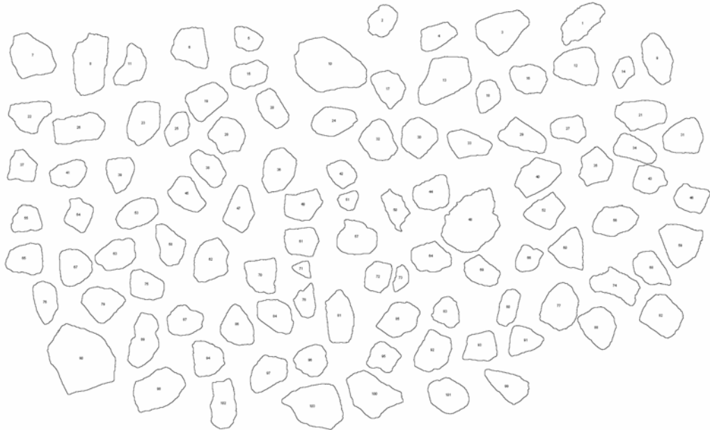
Şekil 4.44. Boyutları daha önceden bilinmeyen taş parçalarının miktarlarının ve tane boyutlarının belirlenmesi
