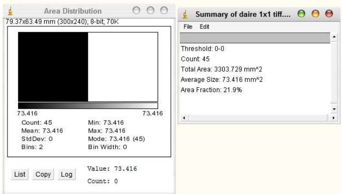
Şekil 4.30. 1 cm çaplı daire objelerin belirlenmesi, analiz özeti ve sonuçlarının kaydedilmesi
