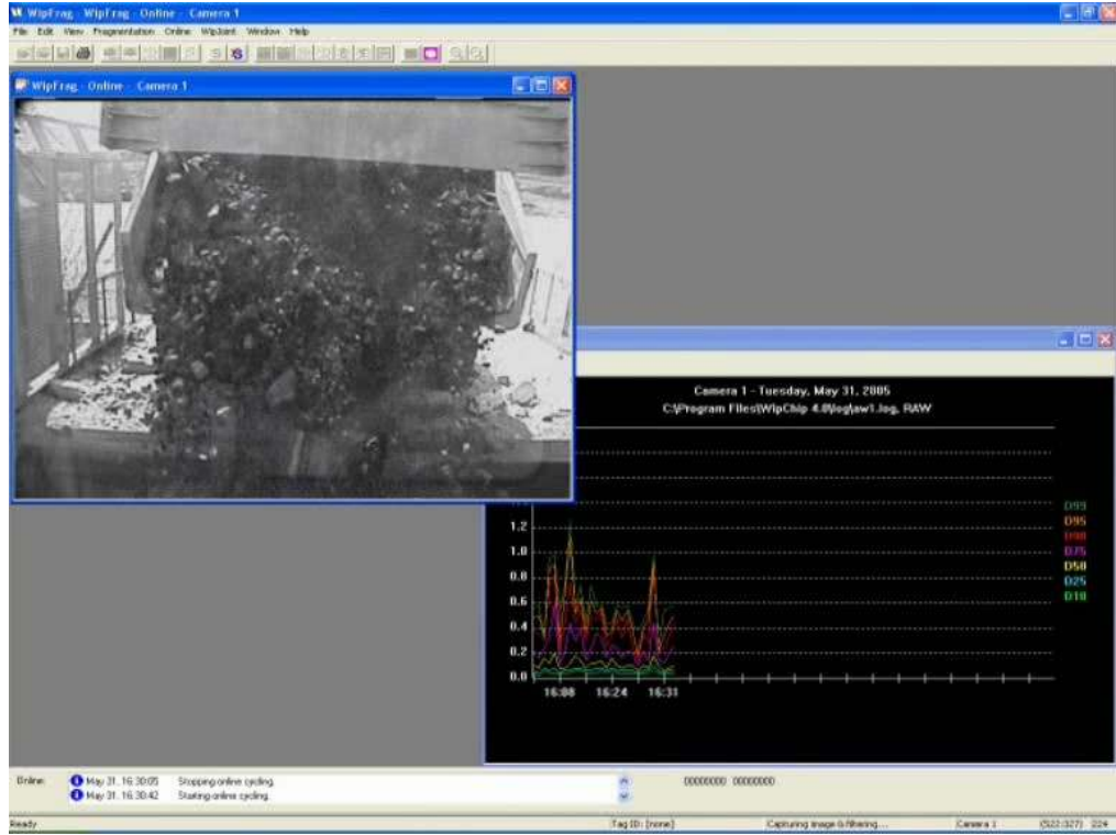
Şekil 1.70. Madencilikte dijital görüntü işleme yardımıyla parça boyut dağılımı analizi(Wipfrag,2005)
