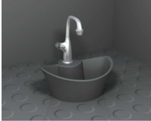
Şekil 3.29 Sensable Technologies firmasının, dokunma hisli donanım kullanarak, Freeform modelleme sistemi ile modellenmiş bir lavabo ve batarya [12]
