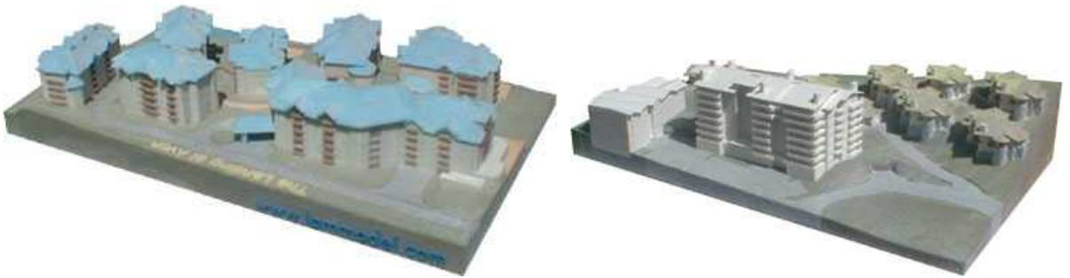
Şekil 3.44 Üç boyutlu yazıcı ile inşaa edilmiş bina modelleri [24]
