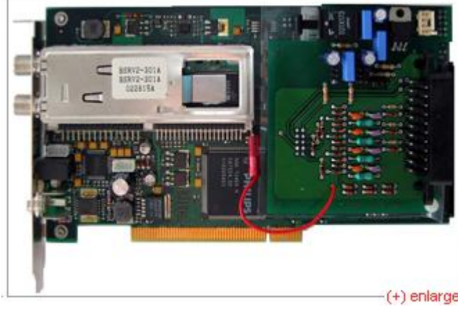
Şekil 2.3. PCI sayısal uydu (DVB-S) kanal bulucu.
