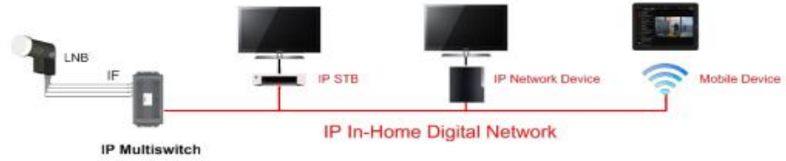
Şekil 4.6 IP Bağdaştırıcı/Çoklayıcı kullanım senaryosu.
