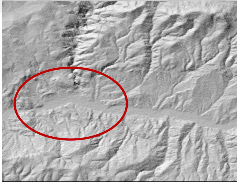
Şekil 4.119: Verinin sadece gölgeleme yöntemi uygulanmış hali
