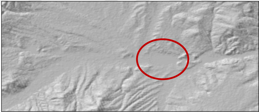
Şekil 4.141: Verinin önce çukur doldurma daha sonra gölgeleme yöntemi uygulanmış hali
