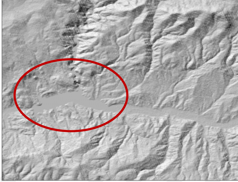
Şekil 4.120: Verinin önce çukur doldurma daha sonra gölgeleme yöntemi uygulanmış hali
