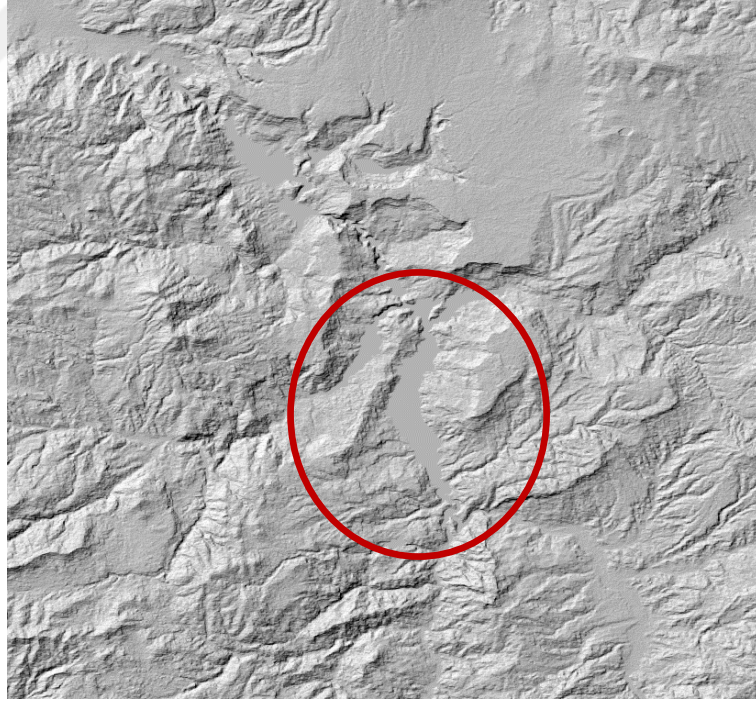
Şekil 4.11: Veride çukur doldurma yöntemi uygulandıktan sonra değişim olan yerlerden bir kısmı
