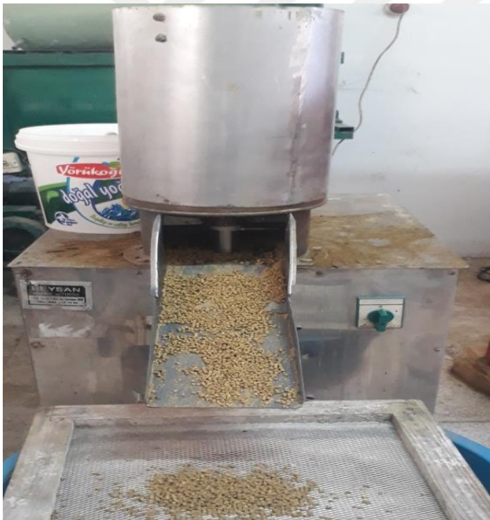
Şekil 3.3. Deneme yemlerinin pelet makinesinde peletlenmesi
