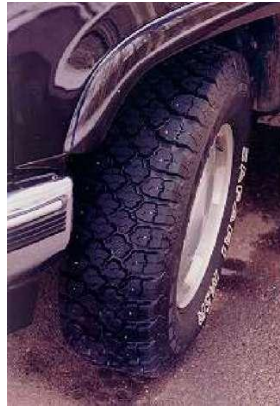
Şekil 1.8. Çivili lastik görünümü (studded tire)
