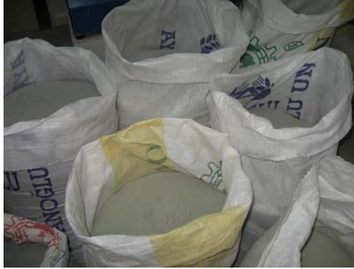
Şekil 2.1. Çeşitli boyutlarda elenerek depolanan agregalar
