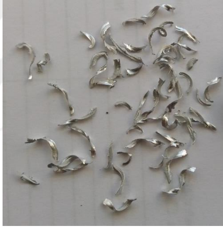
Şekil 5.1. Çalışmada kullanılan Al7050 talaş formu
