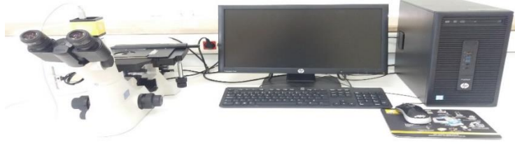
Şekil 5.7. Mikroyapısal karakterizasyonda kullanılan metal mikroskobu
