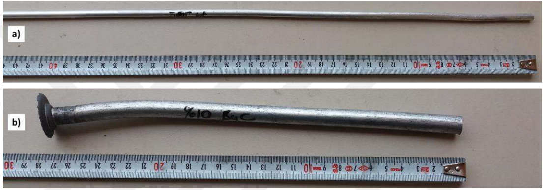
Şekil 5.6. Ekstrüze edilmiş numuneler, a) çap: 6 mm, b) çap: 12 mm
