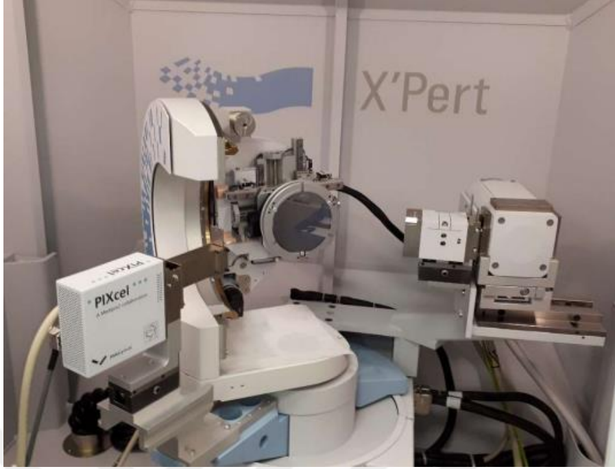
Görsel 3.6. Panalytical X'Pert Pro MRD marka yüksek çözünürlüklü X-ray kırınımı sistemi (HR-XRD)
