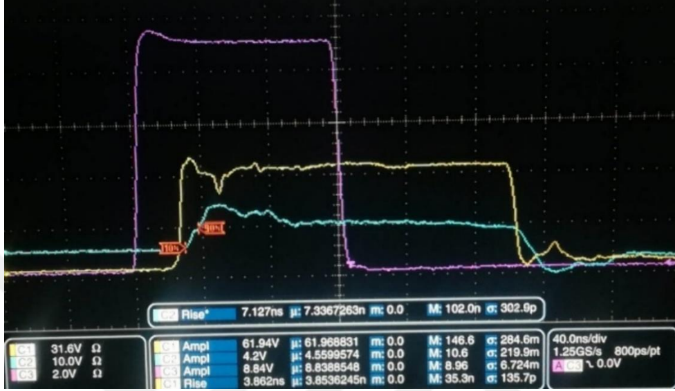
Görsel 3.8. THH aygıtların elektrolüminesans ölçümleri sırasında elde edilen osiloskop ekran görüntüsü.
