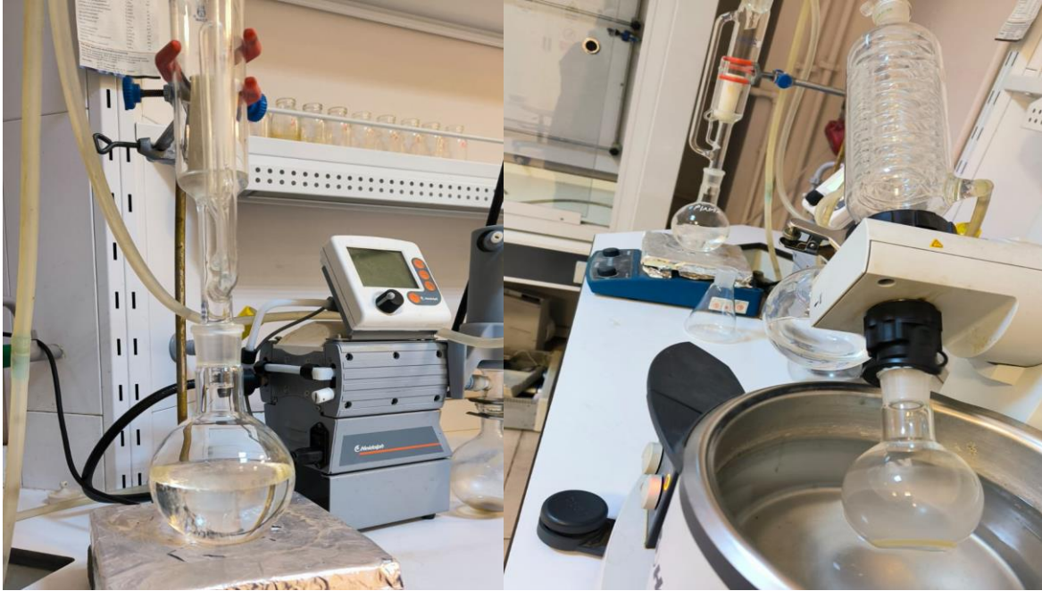
Şekil 8. Soxhlet ekstraksiyon yöntemi ile yağın ayrılması ve çözücünün evaporasyonda uçurulması işlemi
