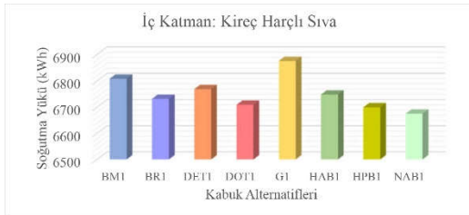
Şekil 4.19: Kireç harçlı sıva için soğutma enerjisi harcamaları.
