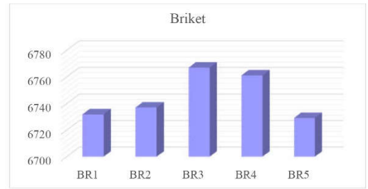
Şekil 4.12: Briket kabuk alternatifleri için soğutma enerjisi harcamaları.
