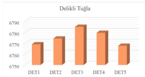
Şekil 4.13: Delikli tuğla kabuk alternatifleri için soğutma enerjisi harcamaları.
