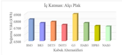
Şekil 4.21: Alçı plak için soğutma enerjisi harcamaları.
