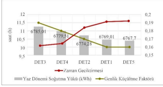
Şekil 4.28: Delikli tuğla kabuk alternatifleri için dinamik ısı özelliklerine göre soğutma enerjisi harcamaları.
