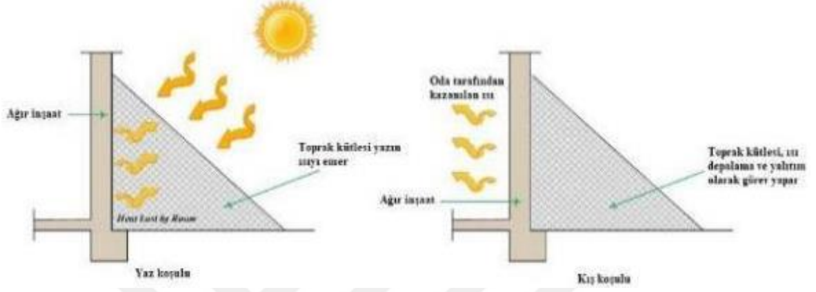
Şekil 12. Toprak soğutma (Kamal, 2012)
