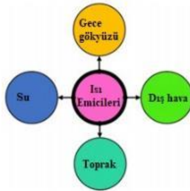
Şekil 13. Farklı türde ısı alıcıları (Kamal, 2012)
