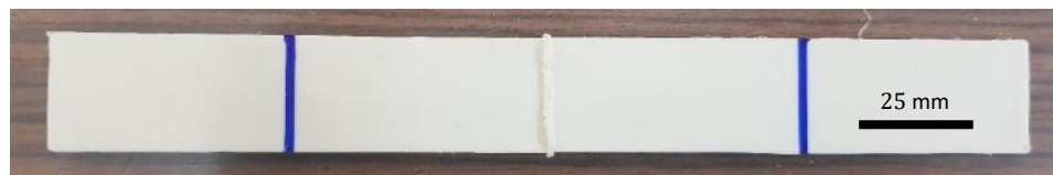
Şekil 3.4 Sıcak plaka kaynağı ile birleştirilmiş kaynak numunesi (Kişisel arşiv, 2018)
