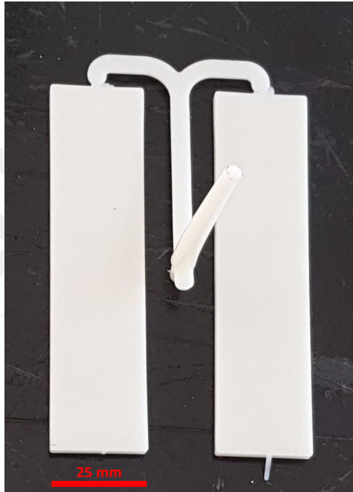
Şekil 3.3 Enjeksiyon kalıbından çıkarılmış numune çifti (Kişisel arşiv, 2018)
