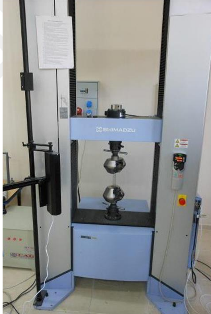
Şekil 5.1 Shimadzu AG-X çekme testi cihazı (Kişisel arşiv, 2018)
