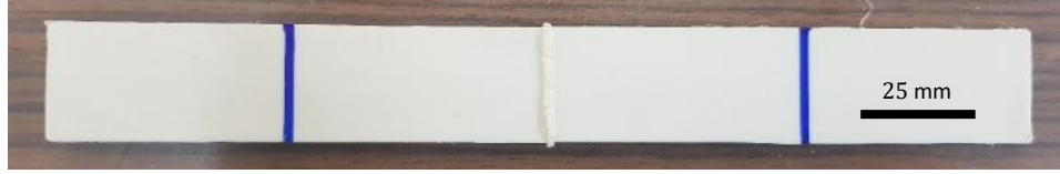
Şekil 5.2 Sıcak plaka kaynağı ile birleştirilmiş kaynak numunesi (Kişisel arşiv, 2018)
