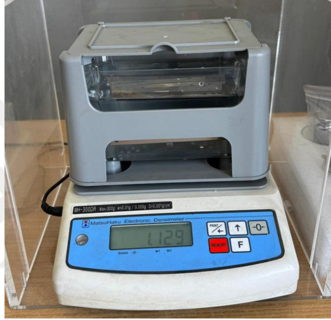
Şekil 3.2 MatsuHaku MH-300DR elektronik yoğunluk ölçer makinesi
