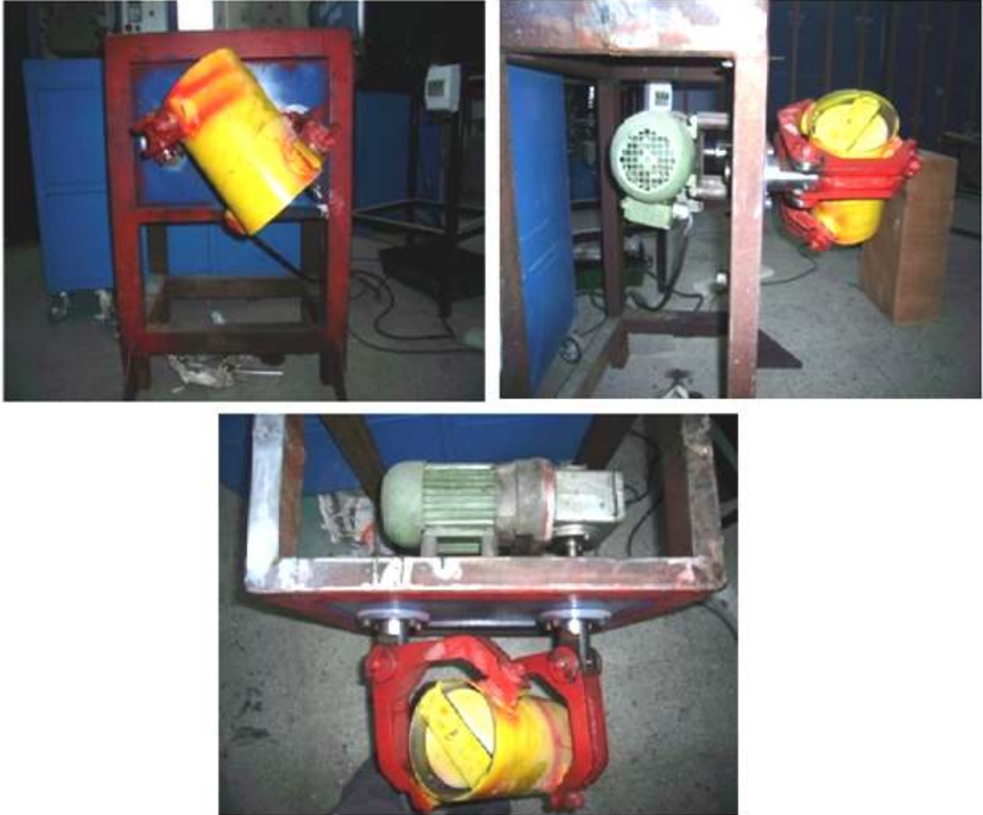
Şekil 2.9. Numunelerin üretiminde kullanılan 88-tipi mikserin ön, yan, üst görünüşü
