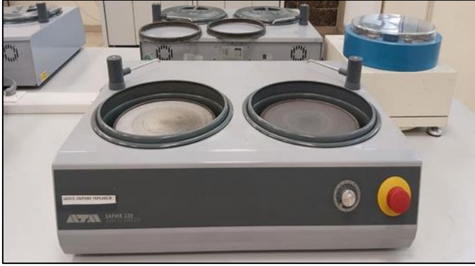
Resim 2.6. ATM SAPHIR 330: Manyetik Çift diskli zımpara-parlatma cihazı
