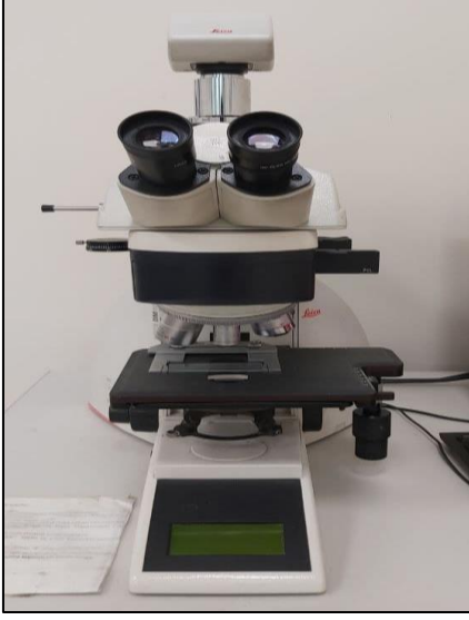
Resim 2.8. LEIKA DM 4000M Metal Mikroskobu
