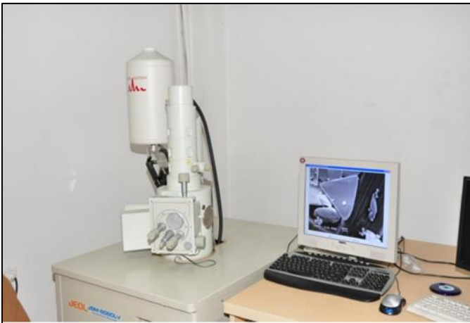
Resim 2.9. JEOL JEM 6060 LV Tarama Elektron Mikroskobu (EDS ünitesi mevcut)
