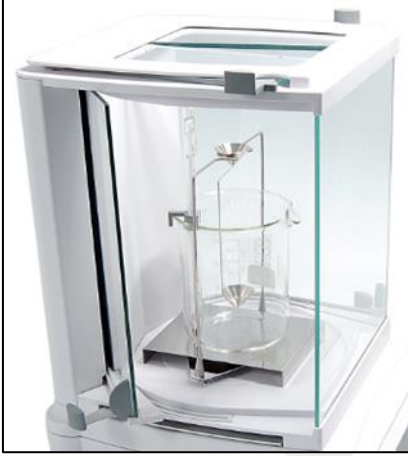
Resim 2.5. Sartorius marka yoğunluk ölçme cihazı
