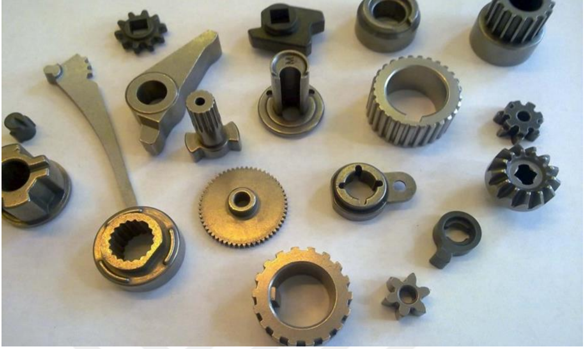
Şekil 4.11. Toz metalurjisi ile üretilmiş bazı parçalar [55]
