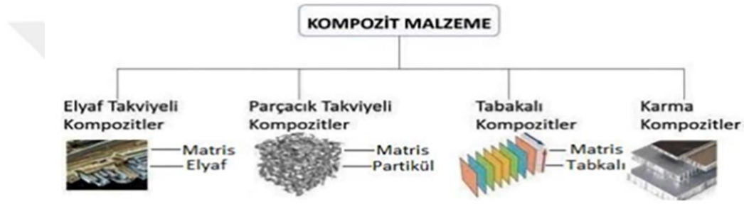
Şekil 2.3. Takviye fazının türüne göre kompozit malzemeler [24]
