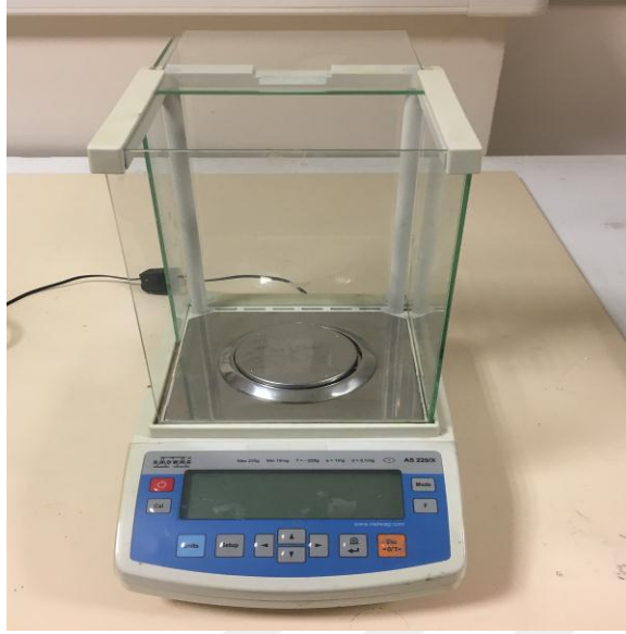
Şekil 3.8. Numunelerin yoğunluk ölçümünde kullanılan hassas terazi
