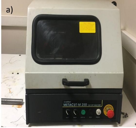
Şekil 3.7. Numunelerin kesme ve parlatma cihazları a) Numune kesme cihazı, b) Numune parlatma cihazı
