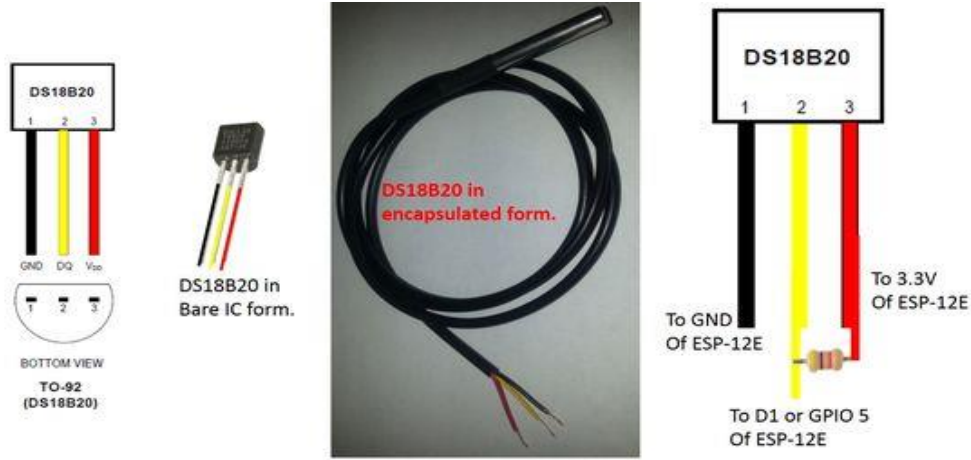
Şekil 4.6. Su geçirmez dijital sıcaklık sensörü (Maximintegrated, 2017).
