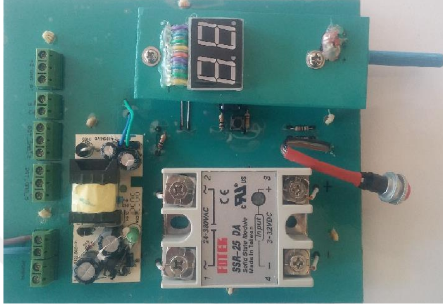
Şekil 5.10. Devre kartının montajlanmış son hali.
