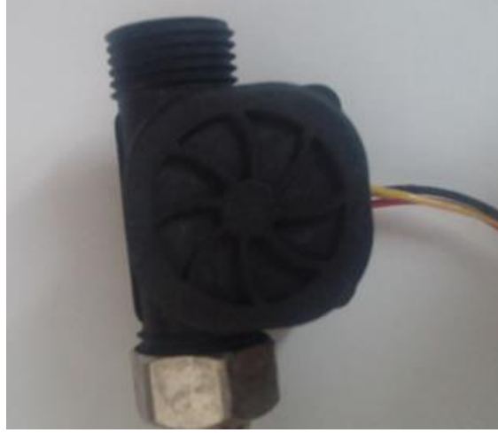
Şekil 4.7. Sıvı akış sensörü fiziksel yapısı.
