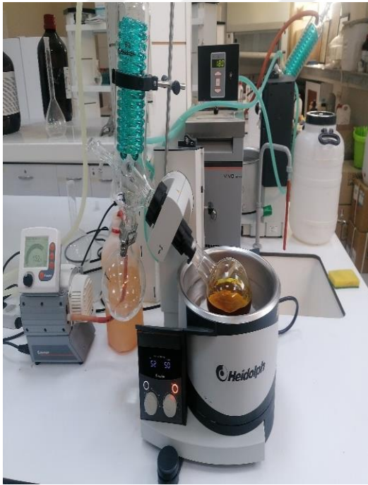
Şekil 9. Kudret narı meyvesinin alkolik özütünün rotari evaporatör ile elde edilmesi
