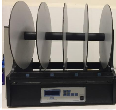
Şekil 3.8. Rotarod motor koordinasyon ve öğrenme testi cihazı
