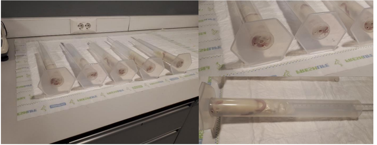
Şekil 3-1 İmmobilizasyon stresi uygulamak için kullanılan plastik aparatlar
