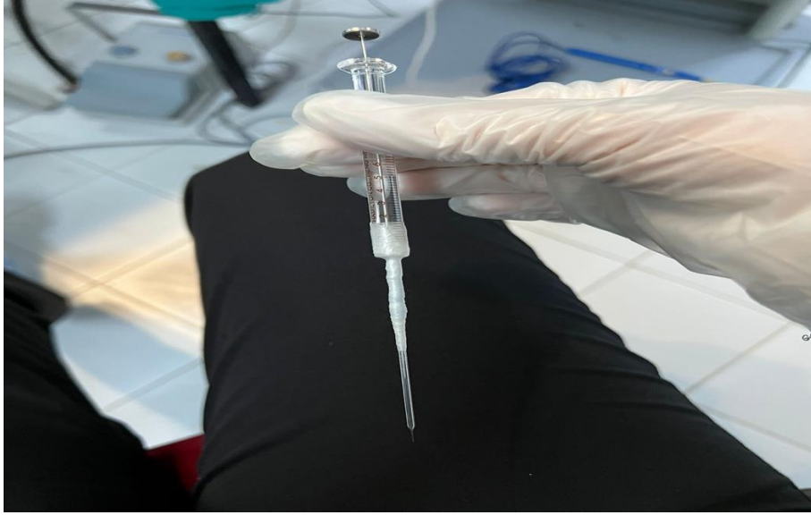
Şekil 3.5. Cam kapiller tüp ile enjeksiyona hazır hale getirilmiş Hamilton enjektörü
