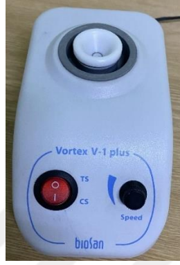
Resim 3: Ritalini suda homojen olarak çözünməsi için kullandığımız vortex V-1 plus cihazı.
