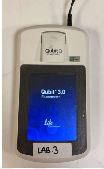
Şekil 3.10. Protein konsantrasyon ölçümünde kullanılan Qubit 3.0 Fluorometer cihazı.
