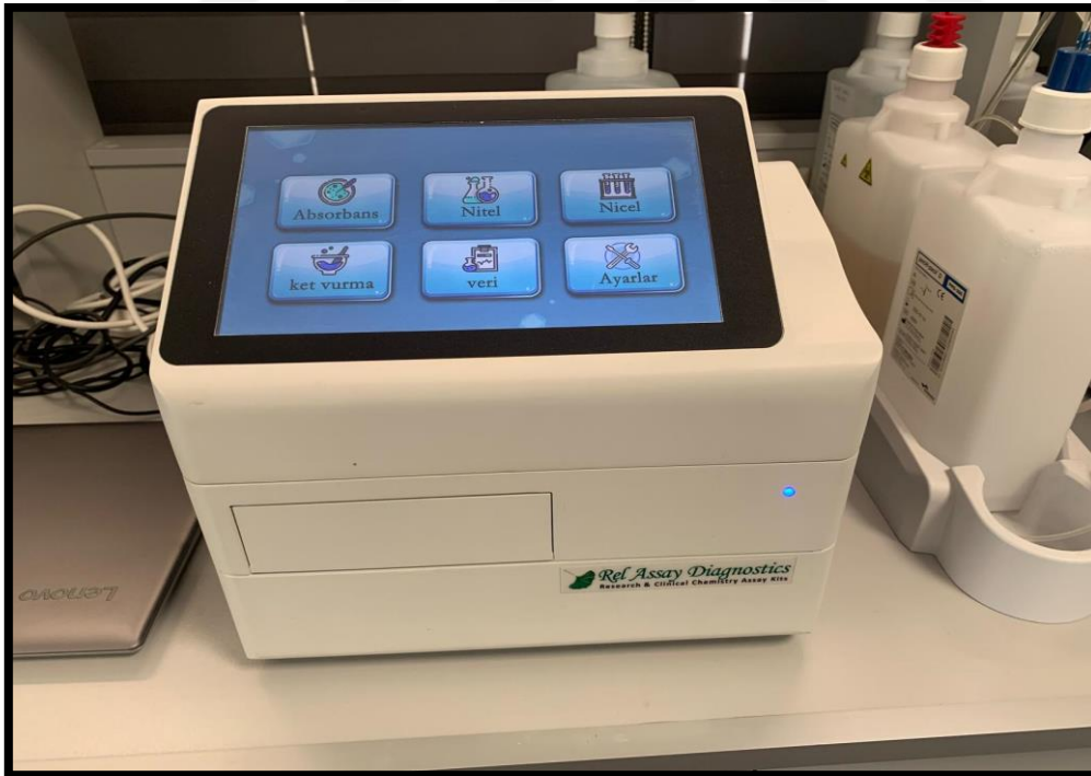
Şekil 9. Biyokimyasal ölçümlerde kullanılan REL ASSAY cihazı
