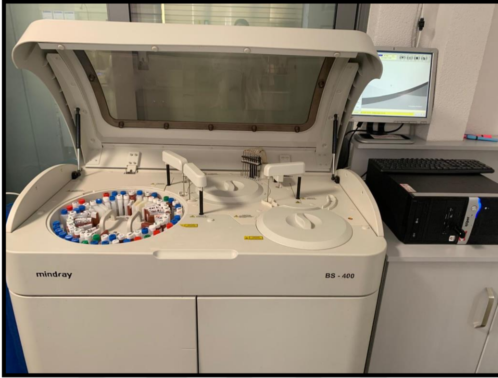
Şekil 8. Biyokimyasal ölçümlerde kullanılan MINDRAY-BS400 cihazı
