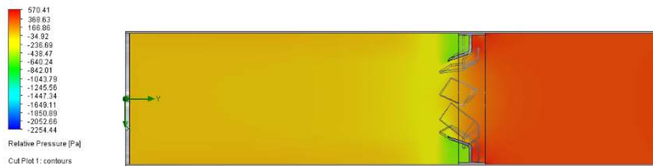
Şekil 4.21. Mikser 21 basınç dağılımı.
