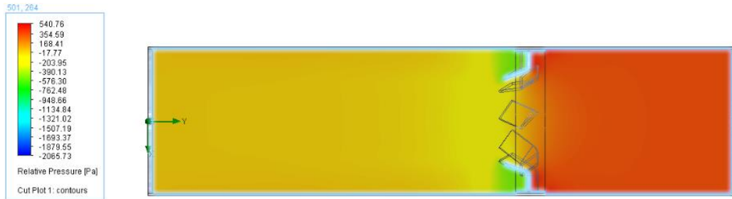
Şekil 4.20. Mikser 20 basınç dağılımı.
