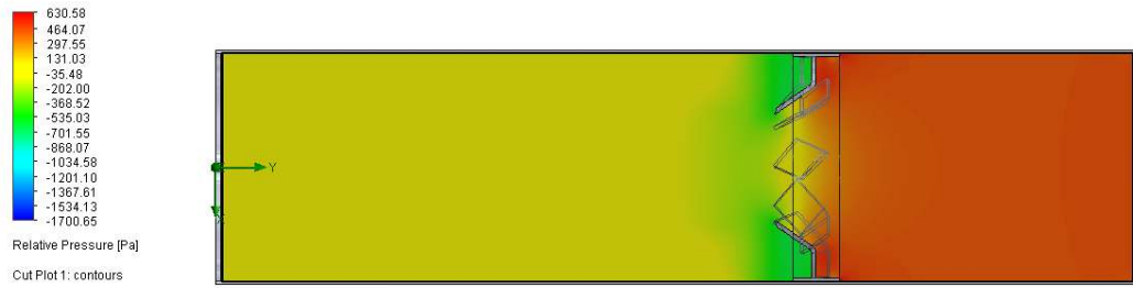
Şekil 4.23. Mikser 23 basınç dağılımı.
