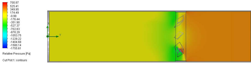
Şekil 4.16. Mikser 16 basınç dağılımı.
