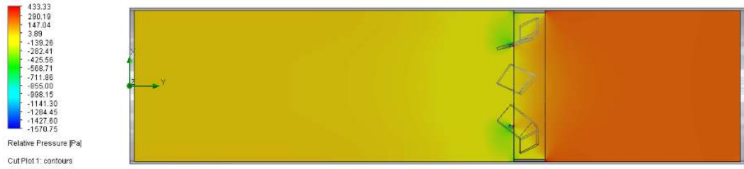
Şekil 4.2. Mikser 2 basınç dağılımı.
