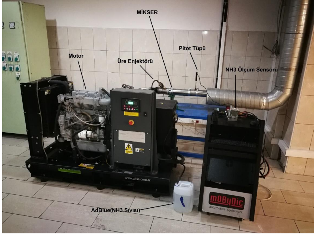
Şekil 3.11. UI NH 3 ölçüm düzeneği.
