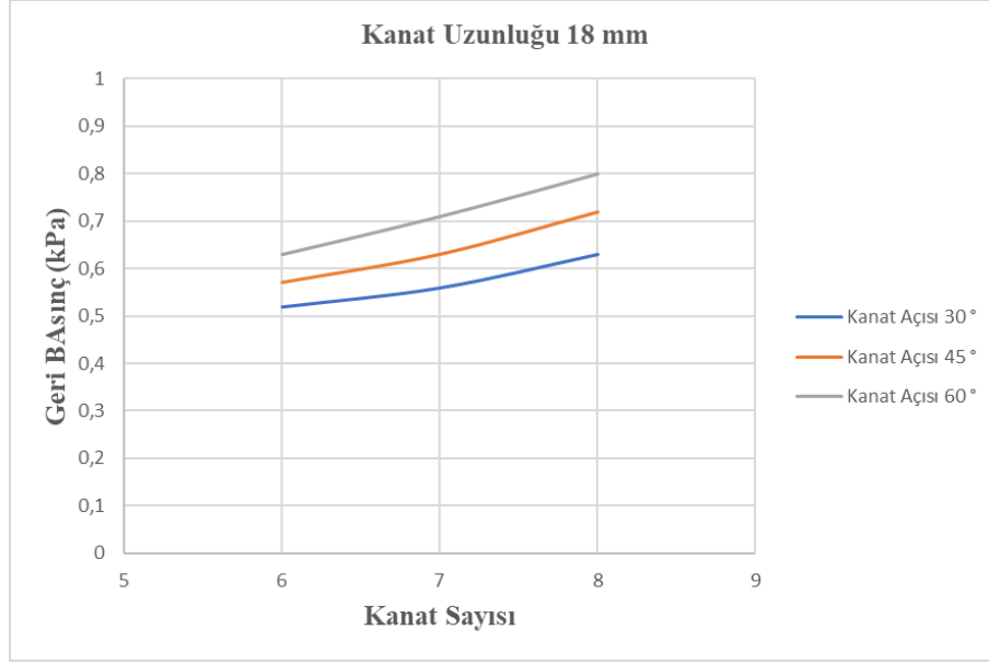
Şekil 4.29. Kanat uzunluğu 18 mm' ye göre geri basınç grafiği.
