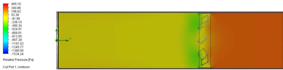
Şekil 4.7. Mikser 7 basınç dağılımı.
