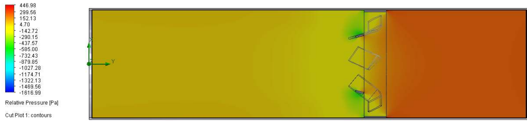
Şekil 4.3. Mikser 3 basınç dağılımı.
