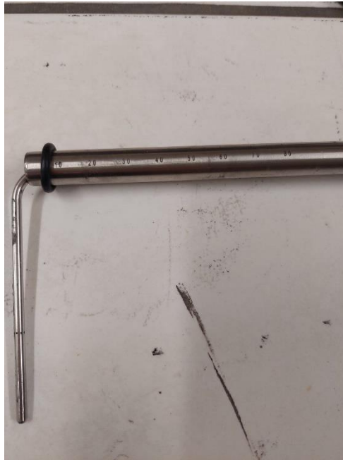
Şekil 3.13. Pitot tüpü ve cetveli.
