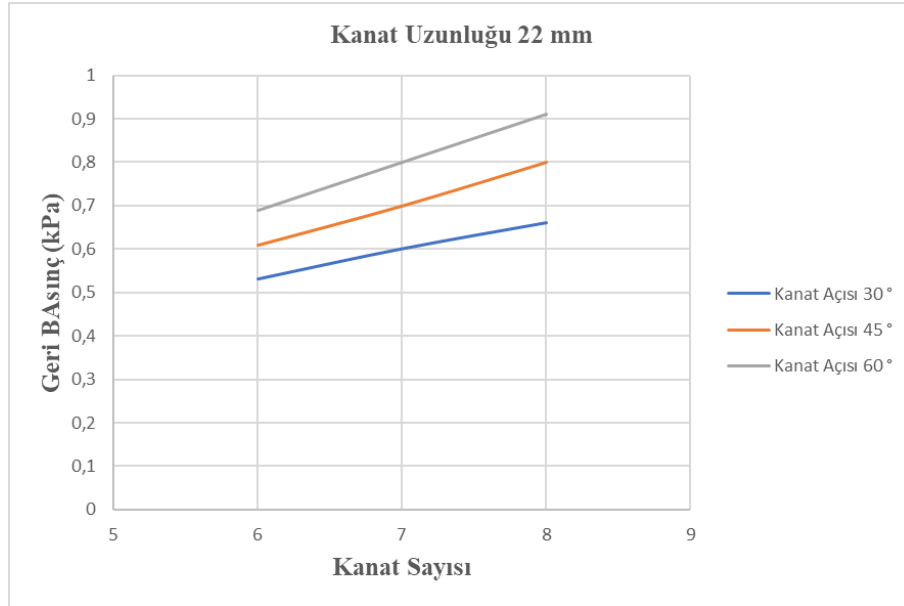
Şekil 4.30. Kanat uzunluğu 22 mm' ye göre geri basınç grafiği.
