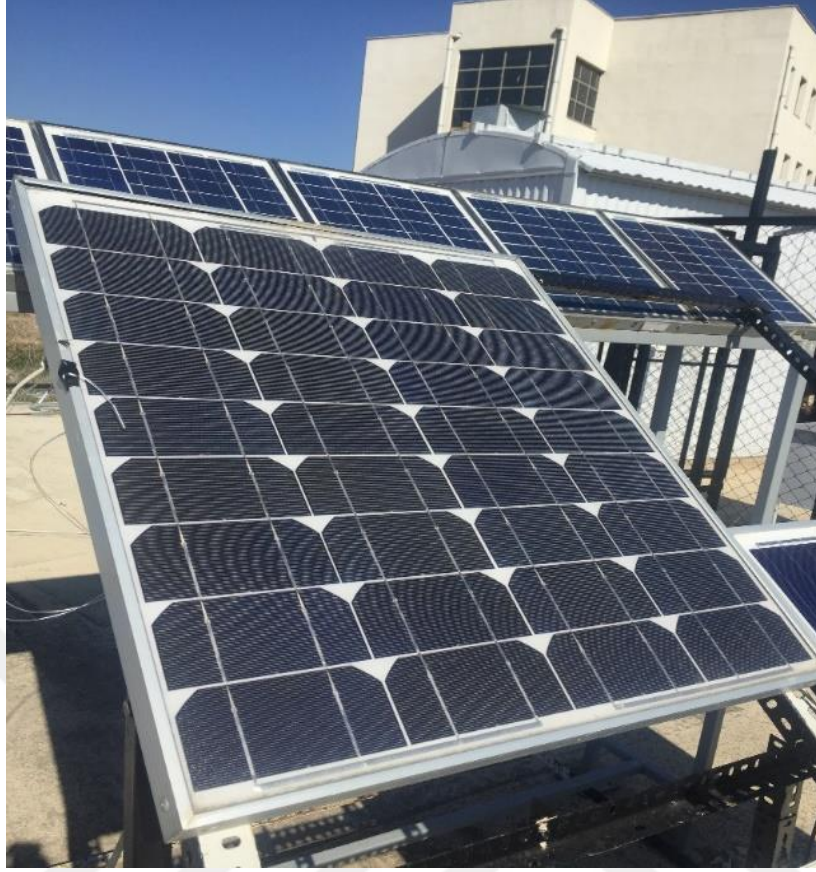
Resim 3.2 İsofoton ISF-60/12 fotovoltaiik panel.
