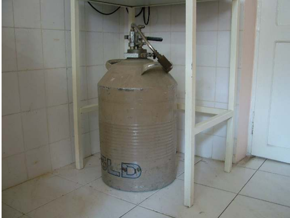
Resim 1 BR-30 ® Sıvı nitrojen tankı
