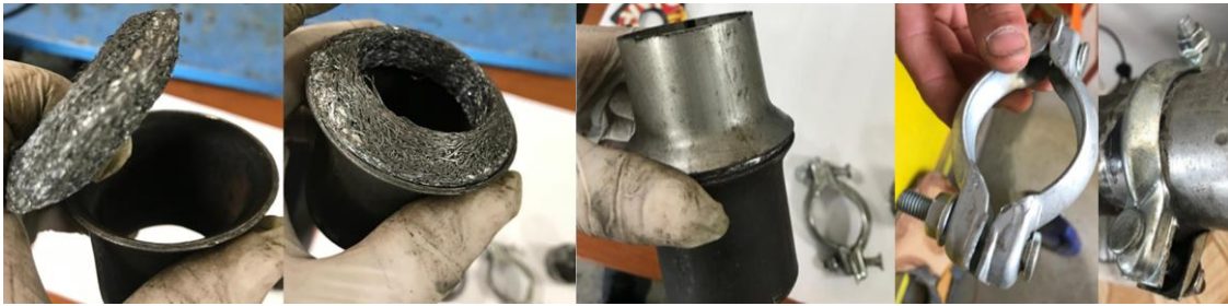
Resim 3.28 Egzoz parçaları conta ve kelepçe ile birleşimi.
