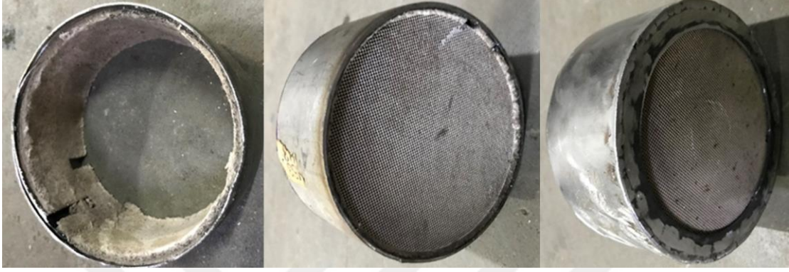
Resim 3.24 Amyant ve katalizöre giydirilmesi.
