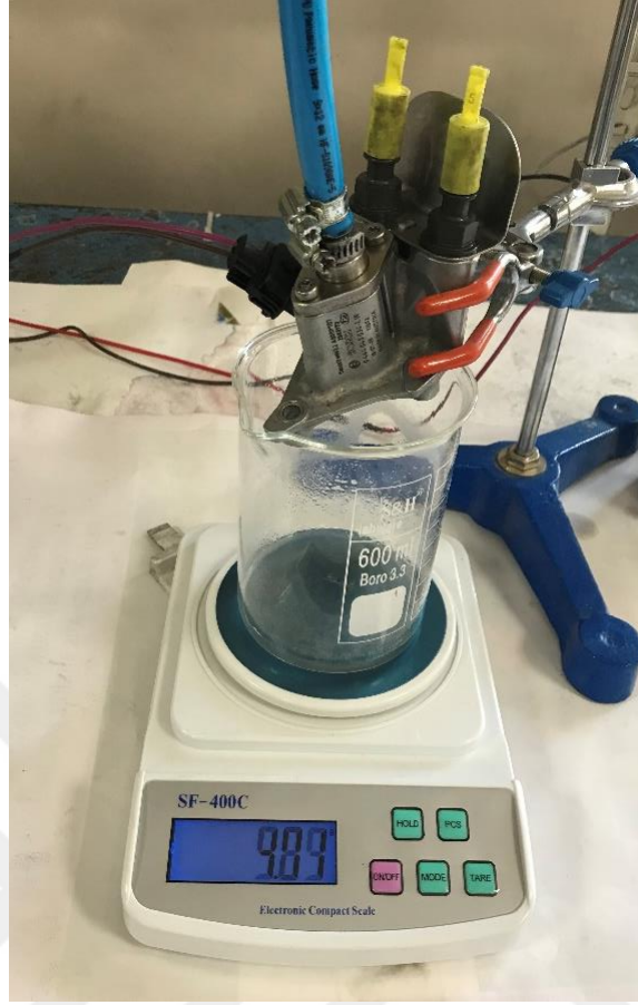
Resim 3.30 Püskürtülen DEF sıvısının hassas ölçümü.
