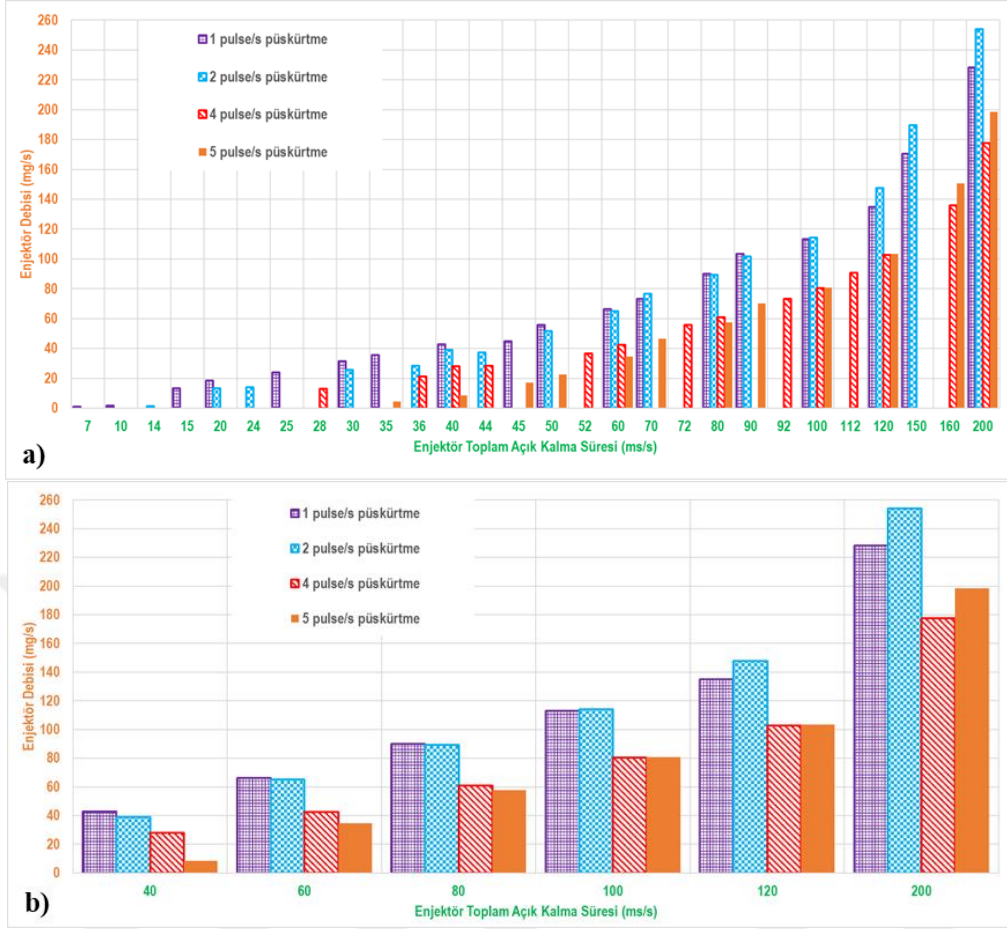
Şekil 3.8 Farklı püskürtme tipleri (pulse) ve sürelerindeki (ms/s) enjektör debisinin (mg/s) değişim grafikleri.
