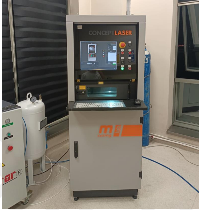
Şekil 3.3. Concept Laser markalı M Lab R model eklemeli üretim seçici lazer ergitme cihazı.
