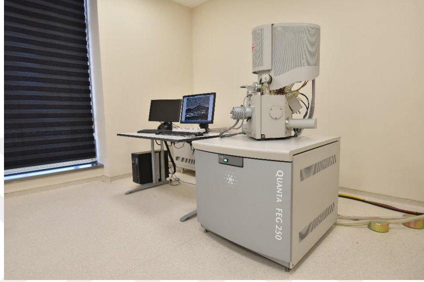
Şekil 3.11 SEM analizlerinin yapıldığı cihaz
