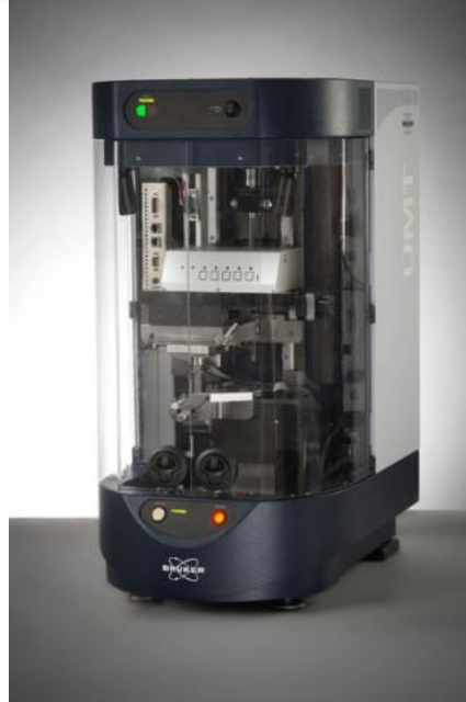
Şekil 3.9 Aşınma testlerinin yapıldığı cihaz görüntüsü
