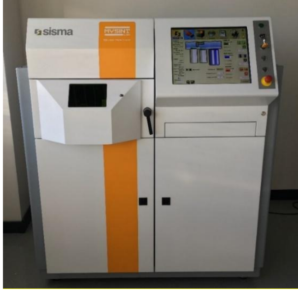
Şekil 2.2. Sisma MYSINT 100 Model Seçici Lazer Ergitme Cihazı
