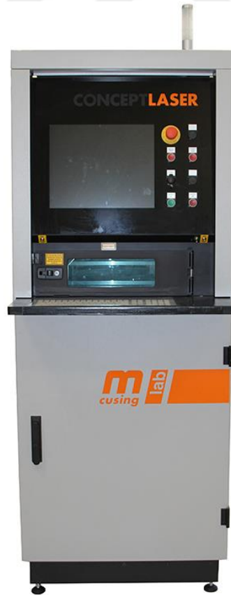
Şekil 3.6. Seçici Lazer Ergitme Cihazı (Consept Laser MLab Cusing R)
