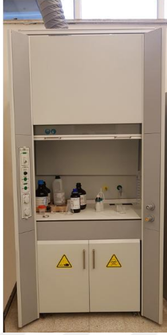
Şekil 2.17. Dağlama esnasında zararlı gazların ortamdan atılması için kullanılan çeker ocak
