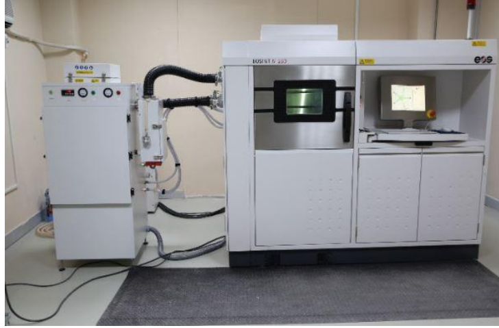
Şekil 2.4. Ti-6Al-4V numunelerinin üretildiği EOSSİNT M 280 cihazı
