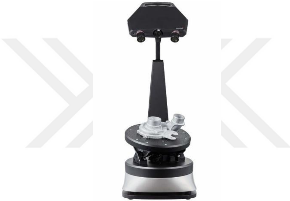
Şekil 2.6. Boyutsal doğrulukta kullanılan Solutionix C500 marka 3D tarama cihazı
