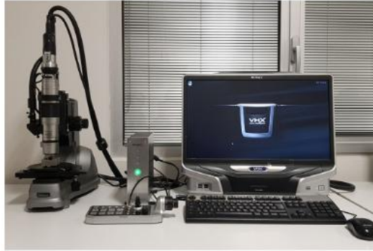
Şekil 2.18. Mikroyapı, aşınma izi, aşınma profili görüntülerinin alındığı optik mikroskop
