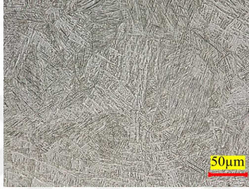
Şekil 2.1. SLE ile üretilen Ti-6Al-4V numunelerine ait mikroyapı görüntüsü
