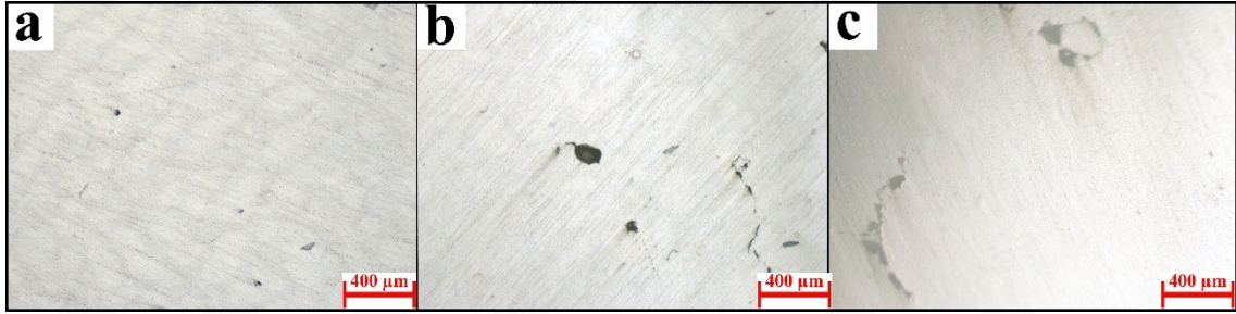
Şekil 4.22. Isıtıl işlem uygulanmayan ve ısıtıl işlem uygulanan numunelere ait optik mikroskop görüntüsü a) AB, b) AN ve c) T6
