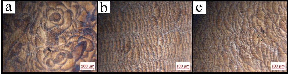
Şekil 4.19. Farklı inşa açılarıyla üretilen prizmatik numunelerin optik mikroskop görüntüleri a) 0°, b) 45°, c) 90°
